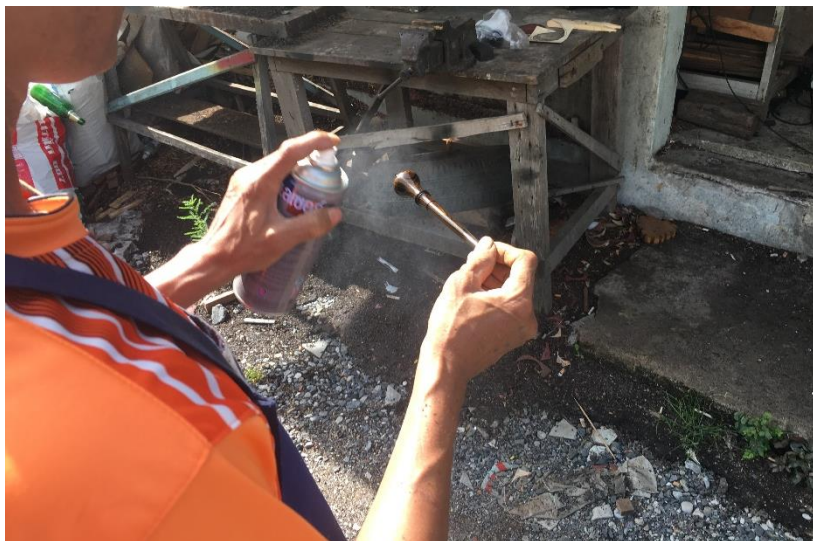
ภาพที่ 4.70 การใช้แล็กเกอร์พ่นที่ชิ้นงาน
