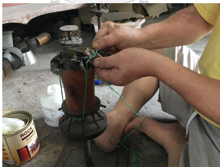
ภาพที่ 4.24 การใช้เชือกโพลีโพรลีนคล้องตะขอเครื่องขึ้นหนังแล้วไปคล้องกับตะปูที่กลัดหนัง
