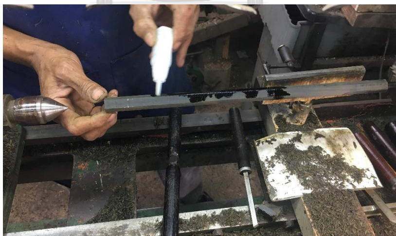
ภาพที่ 4.73 การใช้ความร้อนตามรอยแตกของเนื้อไม้ก่อนนำซีลรอยโรยทับ
