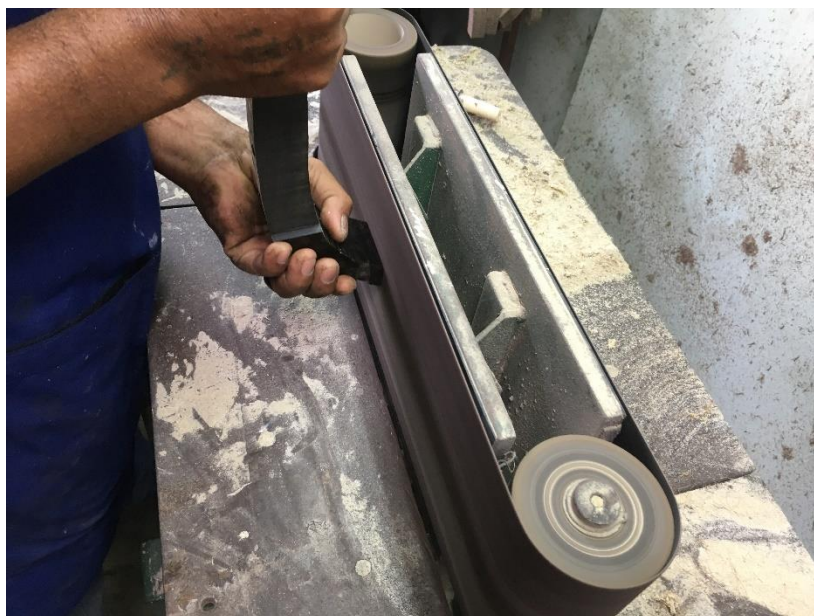
ภาพที่ 4.47 การนำไม้ที่เลื่อยแล้วมากลึงด้วยกระดาษทรายเบอร์ 40 เพื่อลบลอยคม
