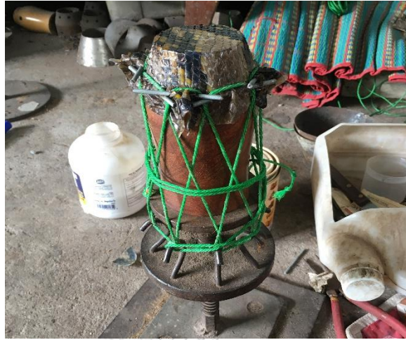
ภาพที่ 4.26 กระบอกซอที่ขึ้นหนังขึ้นหนังเสร็จเรียบร้อยแล้ว
