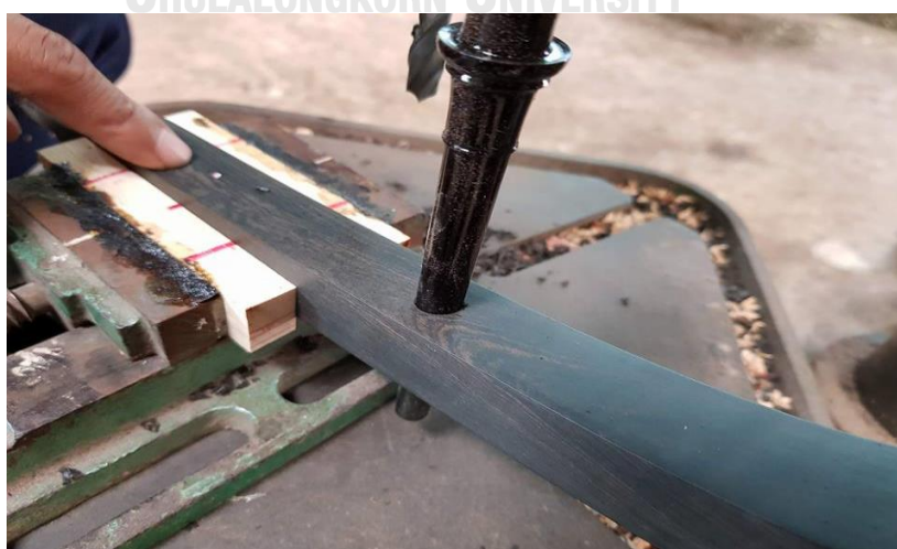
ภาพที่ 4.54 การนำลูกบิดมาทดลองใส่รู(บน)ที่เจาะ
