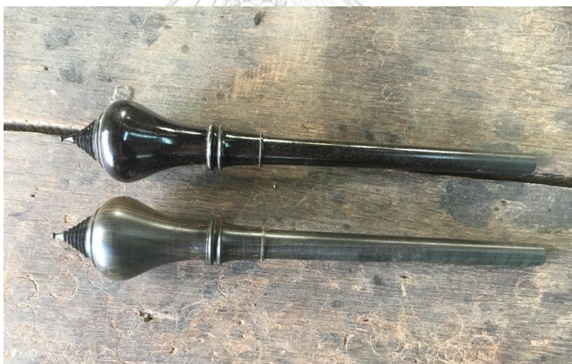
ภาพที่ 4.71 การเปรียบเทียบลูกบิดต้นแบบ (ด้านบน) และลูกบิดที่กลึงเสร็จแล้ว (ด้านล่าง)
