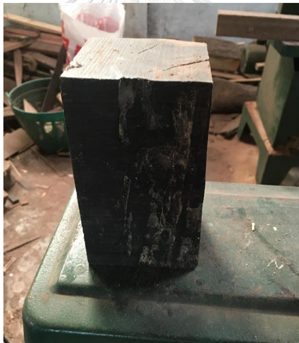
ภาพที่ 4.2 ไม้ที่เลื่อยเป็นทรงสี่เหลี่ยมสำหรับเตรียมกลึงเป็นกระบอบอกซอด้วง
