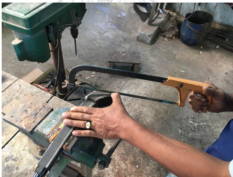
ภาพที่ 4.50 การใช้เลื่อยมือเลื่อยชิ้นงานอีกครั้งหนึ่ง
