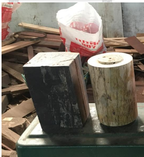
ภาพที่ 4.3 เปรียบเทียบไม้ที่เลื่อยเป็นทรงกระบอกสี่เหลี่ยมกับไม้ที่กลึงเป็นทรงกระบอก
