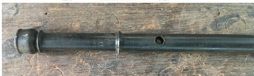
ภาพที่ 4.88 การเจาะรูสำหรับใส่หมุดหางม้าเสร็จแล้ว
