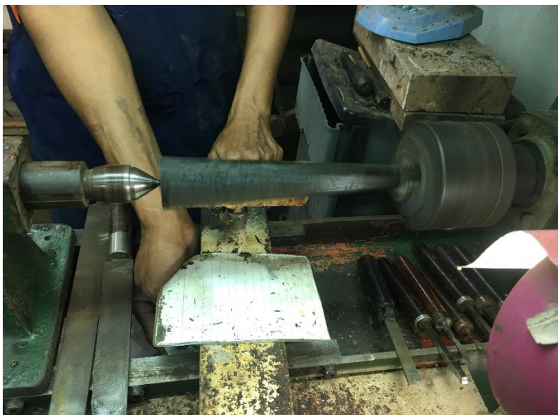
ภาพที่ 4.65 การนำท่อนไม้สำหรับกลึงลูกบิดประกอบเข้าไปในเครื่องกลึง
