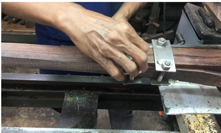
ภาพที่ 4.37 การนำท่อนไม้ยึดกับเหล็กก่อนทำการกลึง
