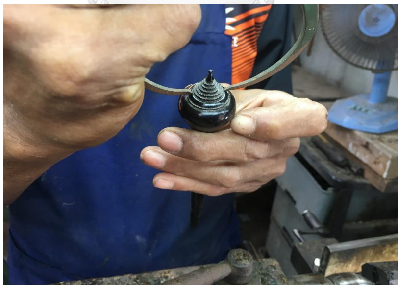
ภาพที่ 4.62 การใช้เชาควายวัดยอดของลูกบิด
