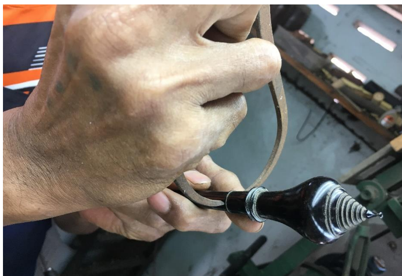
ภาพที่ 4.63 การใช้เขาควาวัดลูกแหวนที่ข้อของลูกบิด
