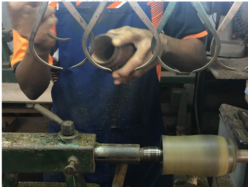
ภาพที่ 4.10 การนำเขาควยวัดขนาดจากตัวต้นแบบ
