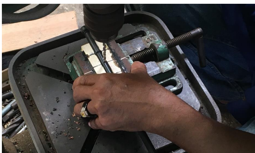
ภาพที่ 4.87 การเจาะรูสำหรับใส่หมุดหางม้า
