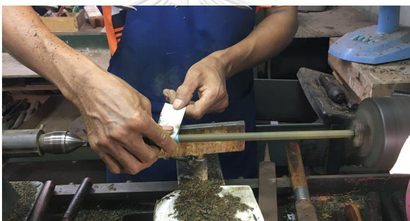
ภาพที่ 4.78 การนำกระดาษทรายมาขัดคั่นชักเพื่อเพิ่มความละเอียดของชิ้นงาน
