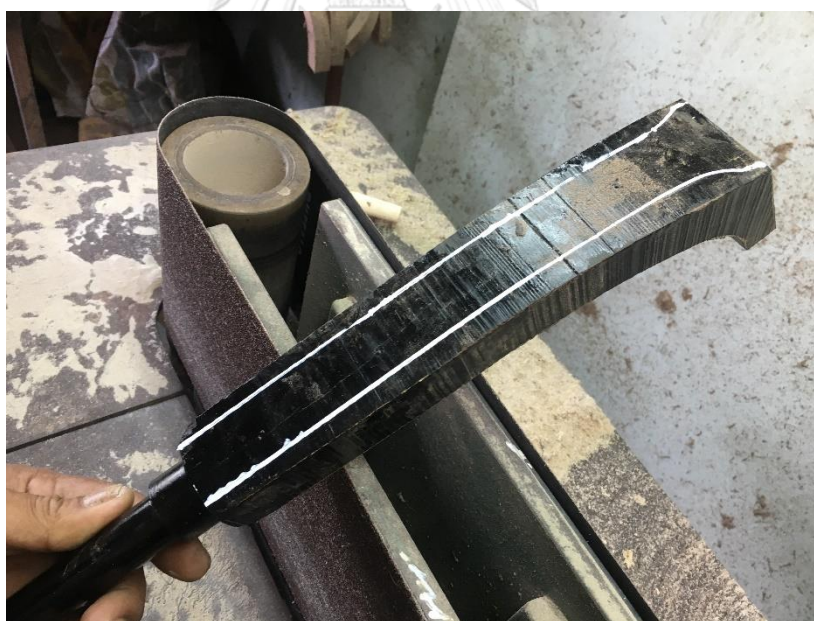
ภาพที่ 4.42 เมื่อวัดเรียบร้อยแล้วจึงใช้น้ำยาลบคำผิดสีขาววาดรอยตามแบบบนไม้
