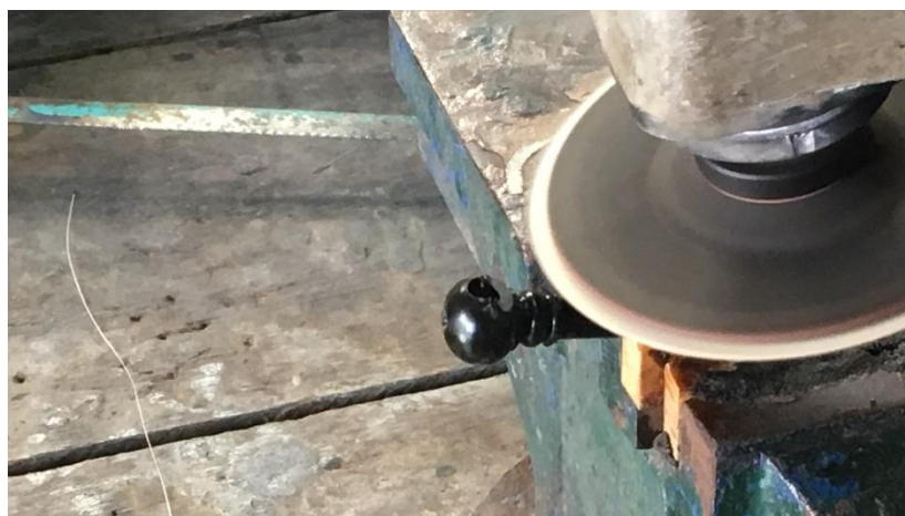
ภาพที่ 4.84 การใช้เครื่องเจียรบากรูยอดคันทันชัก
