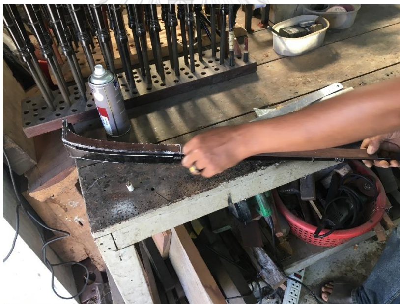
ภาพที่ 4.48 การวัดด้านข้างของคันทวนขอด้วงกับแบบคันทวน
