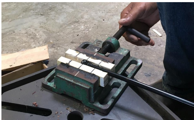
ภาพที่ 4.80 คันทักส่วนหัวเข้าปากจับชิ้นงานก่อนนำเข้าเครื่องเจาะ
