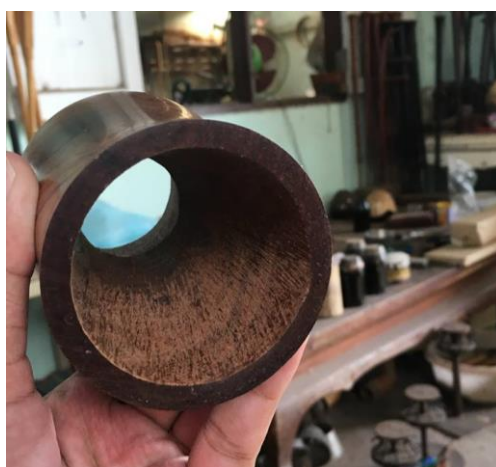
ภาพที่ 4.15 ลักษณะภายในกระบอกลบที่ใช้บุงเสร็จเรียบร้อยแล้ว
