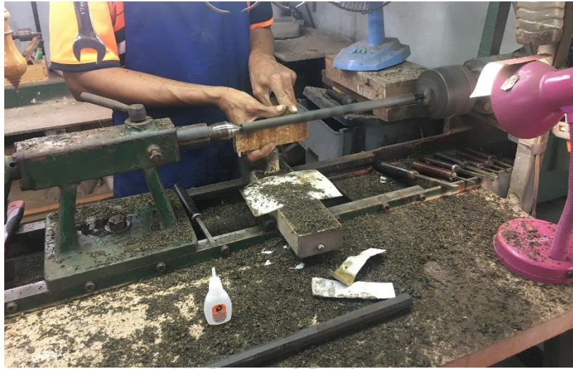
ภาพที่ 4.74 ขั้นตอนการใช้มีดกลึงชุดผิวไม้ดอก
