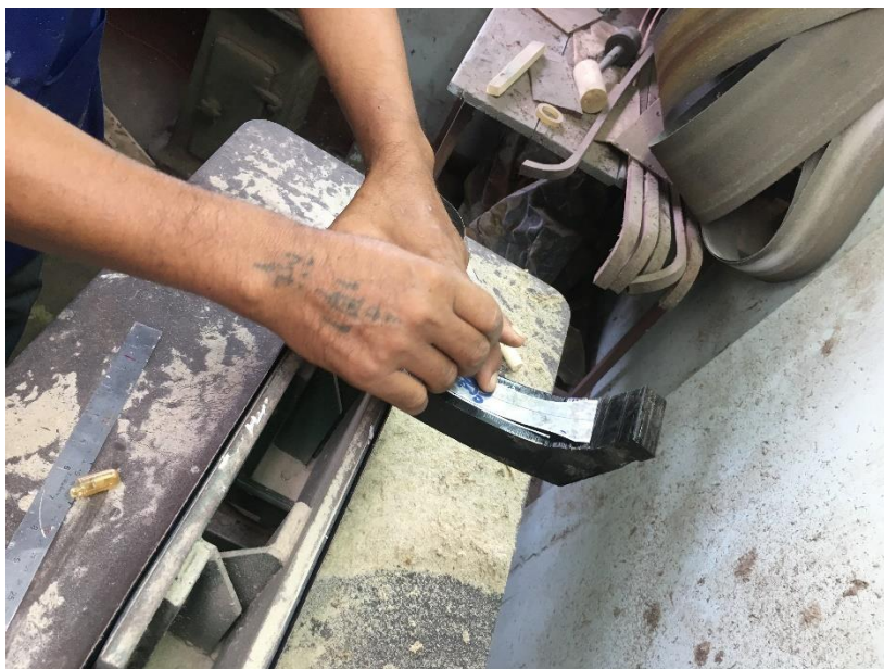
ภาพที่ 4.43 การวัดส่วนโค้งด้านในของโซนสอด้วง
