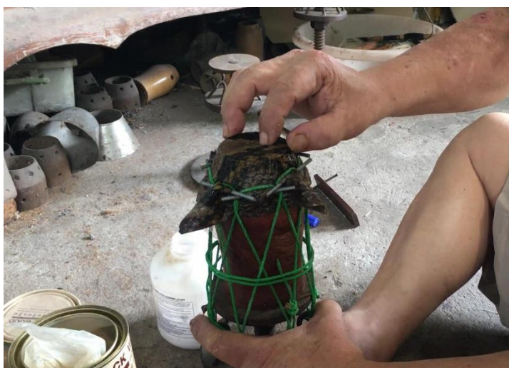
ภาพที่ 4.25 ขั้นตอนการขันเกลียวเครื่องขึ้นหนังควบคุมกับการเคาะหนังงู
