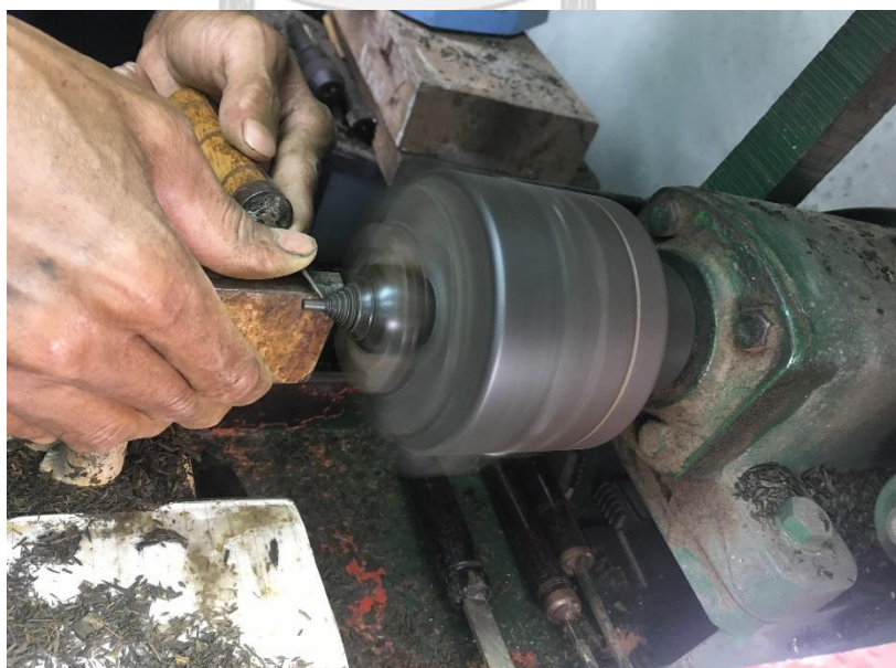
ภาพที่ 4.68 การนำก้านลูกบิดเก็บไว้ข้างในให้โผล่แต่ส่วนหัว
