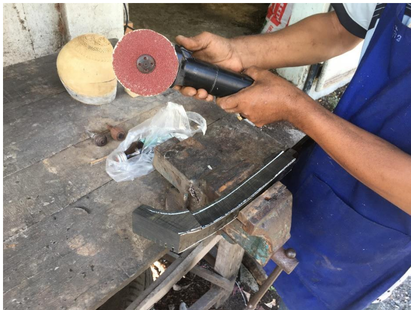
ภาพที่ 4.49 การใช้เครื่องเจียรขัดมุมโค้งต่างๆของไขนซอด้วง
