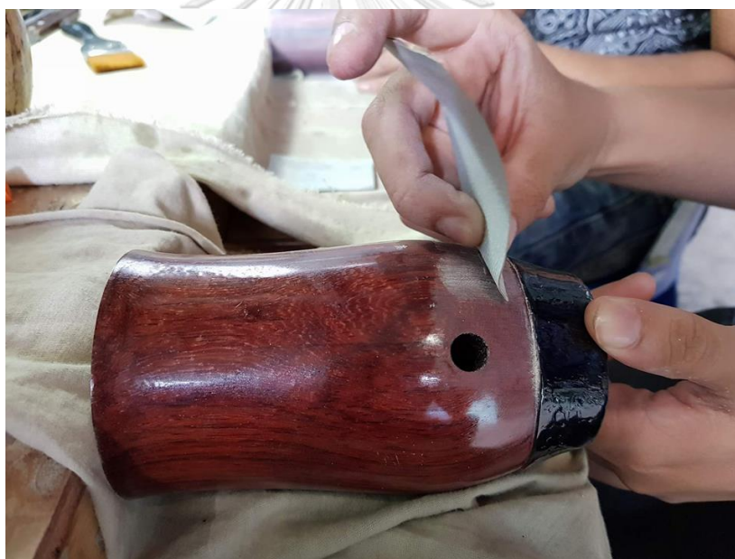
ภาพที่ 4.35 การขัดตกแต่งขอบกระบอกลึงด้วยมือเปล่า
