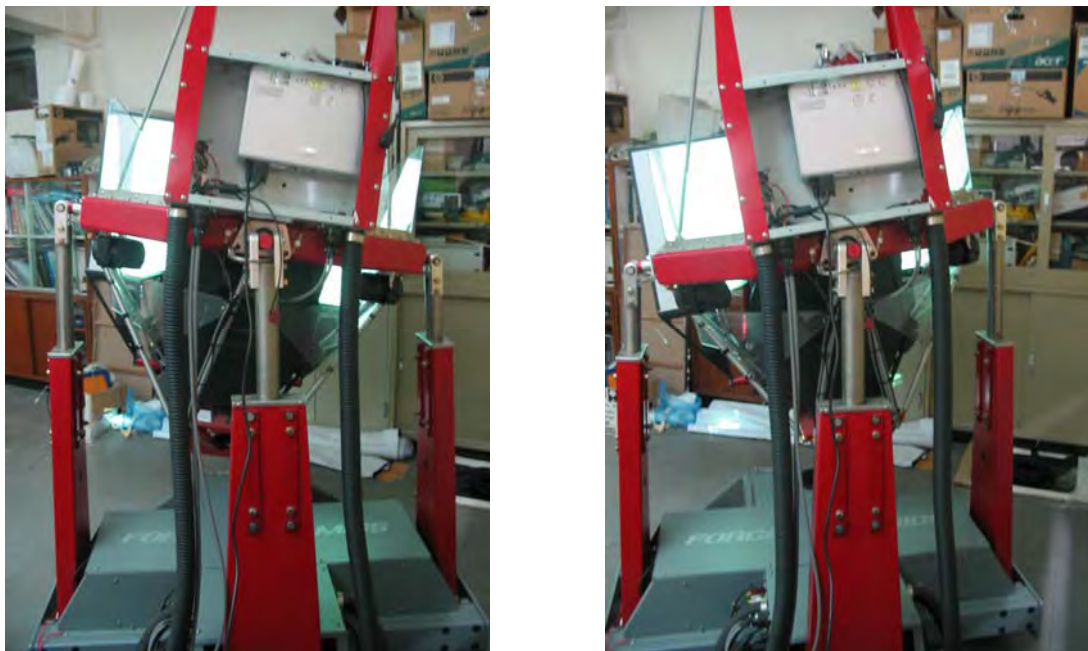
รูปที่ 5.1 การเคลื่อนที่เชิงมุมรอบแกน X (Roll Movement)
