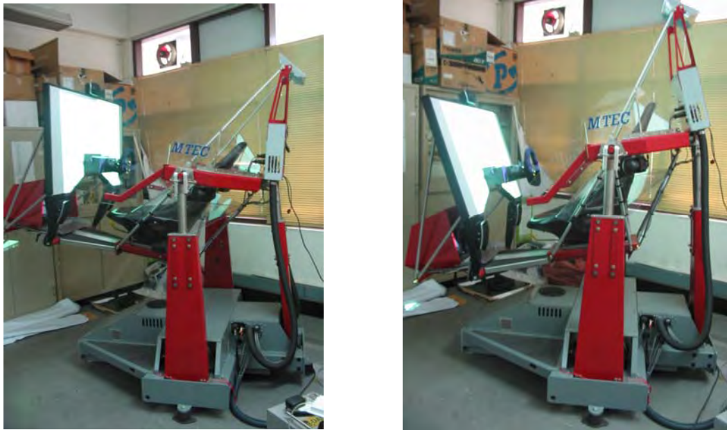
รูปที่ 5.2 การเคลื่อนที่เชิงมุมรอบแกน Y (Pitch Movement)
