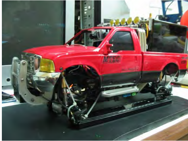
รูปที่ 8.9 การจับยึดยานยนต์ย่อยส่วนเข้ากับรางเลื่อน
