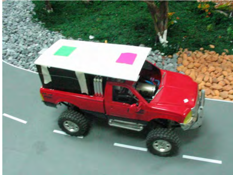
รูปที่ 6.9 ยานยนต์ย่อส่วนที่ติดกระดาษสีเพื่อเป็นจุดอ้างอิงสำหรับกล้องจับภาพ
