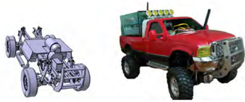
รูปที่ 12 ยานยนต์ย่อส่วน ก่อน (ซ้าย) และหลัง (ขวา) ดัดแปลง
