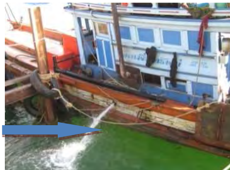
รูปที่ 5.5 จุดเก็บตัวอย่างน้ำขังใต้ท้องเรือที่ปล่อยออกจากเรือประมง ก่อนและหลังเติม PUF-packages ในห้องเครื่องยนต์เรือ
