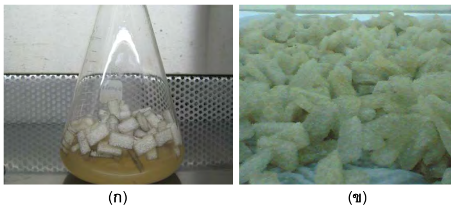
รูปที่ 4.1 การเตรียมเซลล์ตรึงโดยเติมหัวเชื้อ Gordonia sp. JC11 ลงในพลาสติกบรรจุอาหาร NSW ที่มีวัสดุตรึง PUF ปลอดเชื้อ (ก) และเซลล์ตรึงพร้อมใช้ที่ได้จากการตรึงเซลล์ 3 วัน (ข)
