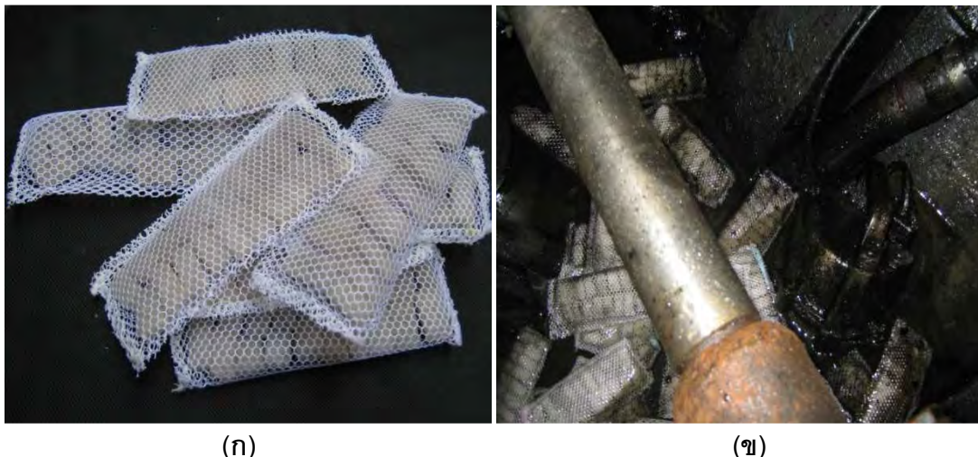
รูปที่ 5.3 PUF-immobilized Gordonia sp. JC11 packages ที่มีพื้นที่ผิวขนาด 40 ซม. 2 / ชิ้น ซึ่งจะสังเกตพบว่าชิ้นโฟมมีสีส้มตามสีของเชื้อ JC11(ก) และที่เติมลงไปในห้องเครื่องยนต์เรือ (ข)
