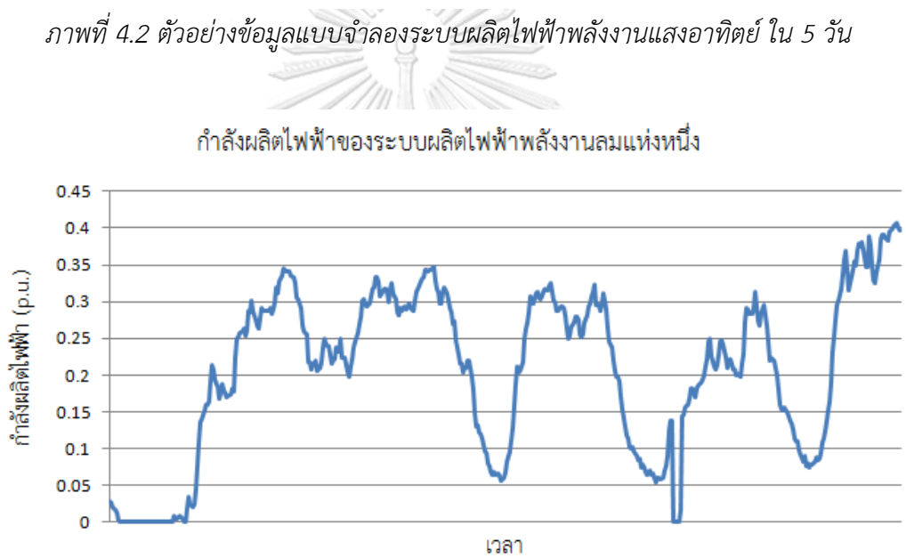
ภาพที่ 4.3 ตัวอย่างข้อมูลกำลังผลิตไฟฟ้าของระบบผลิตไฟฟ้าพลังงานลมแห่งหนึ่ง ใน 5 วัน
