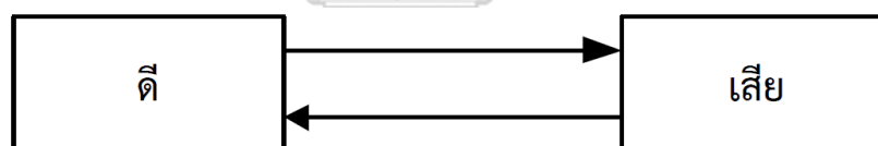
ภาพที่ 4.6 แบบจำลองการทำงานของโรงไฟฟ้าแบบ 2 สถานะ
