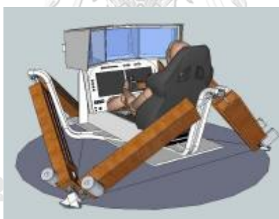
รูปที่ 19 motion 6 degrees of freedom จาก: http://www.simprojects.nl/diy_motion_platform_v.htm
