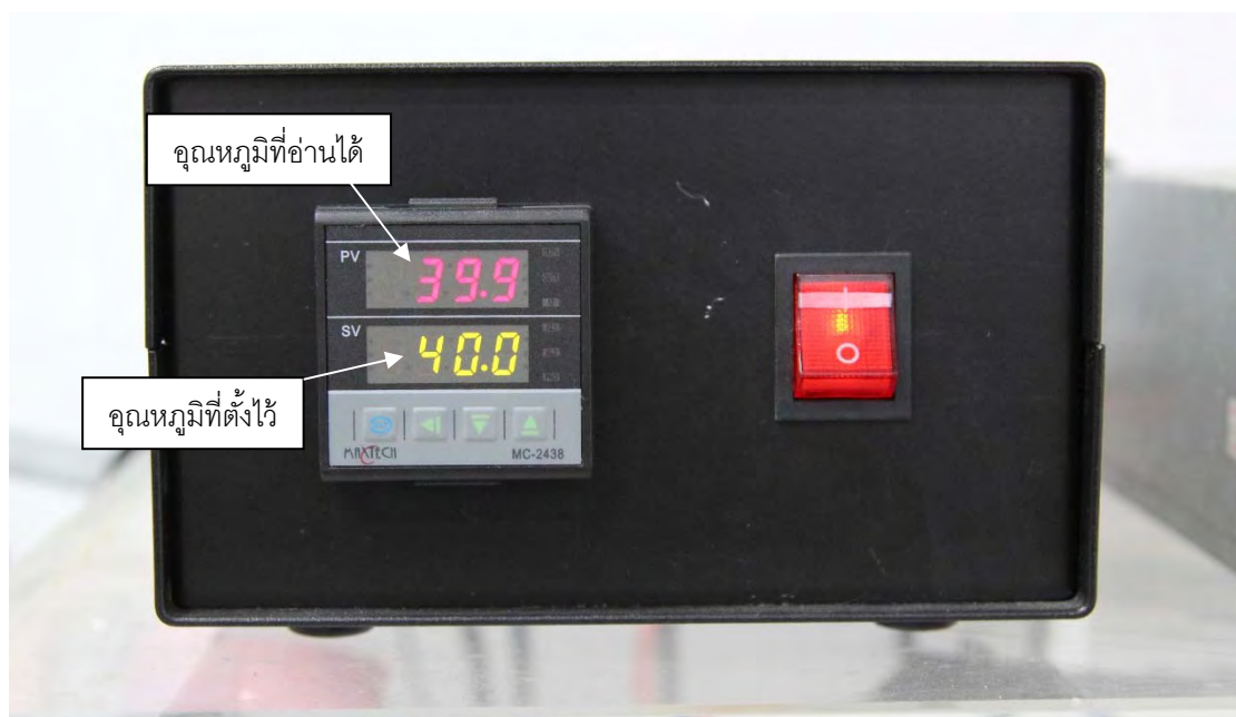
รูปที่ 12 ด้านหน้าของเครื่องควบคุมอุณหภูมิ
