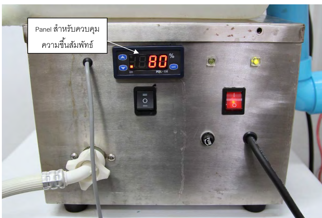
รูปที่ 14 ด้านหน้าของเครื่องกำเนิดไอน้ำ
