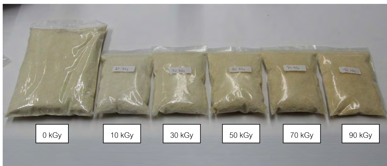
รูปที่ 4 ไคโตซานที่ไม่ได้ฉายรังสีและที่ผ่านการฉายรังสีที่ความแรงรังสีต่างๆ
