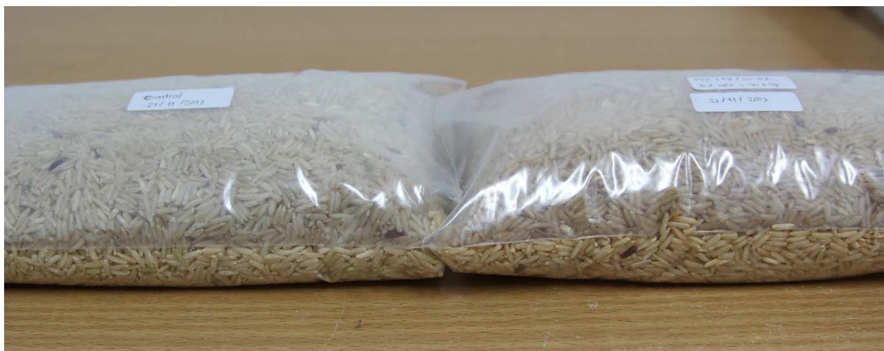
(e) ข้าวกล้องที่บรรจุในถุงพลาสติกใส ถุงด้านขวาเคลือบด้วยโคโตซาน
