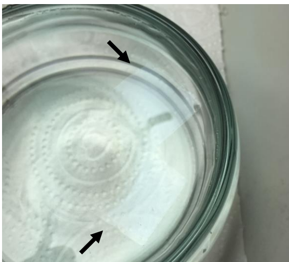
รูปที่ 4: แผ่นฟิล์ม formvar ที่ลอกจากแผ่นสไลด์แก้วและลอยอยู่บนผิวน้ำ (ลูกศร)
