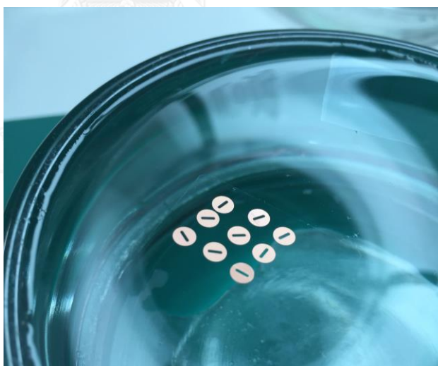
รูปที่ 5: นำ slot grid ที่สะอาดวางลงบนแผ่นฟิล์ม formvar ที่ลอยอยู่บนผิวน้ำโดยให้ด้านเงาของกริดคว่ำลงบนแผ่นฟิล์ม
