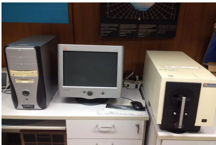
รูปที่ 3. 1 เครื่องวัดสี รุ่น Macbeth color-eye 7000 ของ บริษัท X-rite Incorporated
