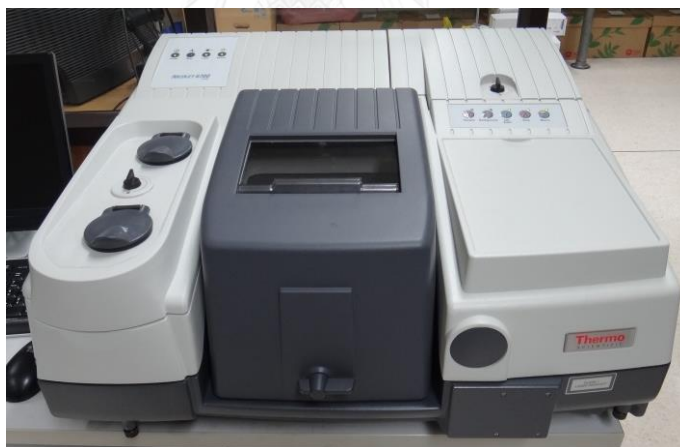
รูปที่ 3.2 เครื่อง FT-IR ของ Thermo Fisher Scientific รุ่น Nicolet 6700
