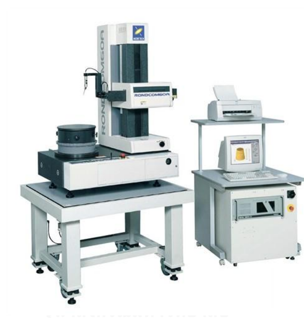
รูปที่ 3.3 เครื่องวัดความกลมยี่ห้อ ACCRETECH รุ่น ROND COM 60A
