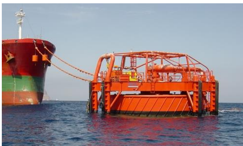
รูปที่ 5-4 ท่อนรับน้ำมันดิบ (single point mooring)
