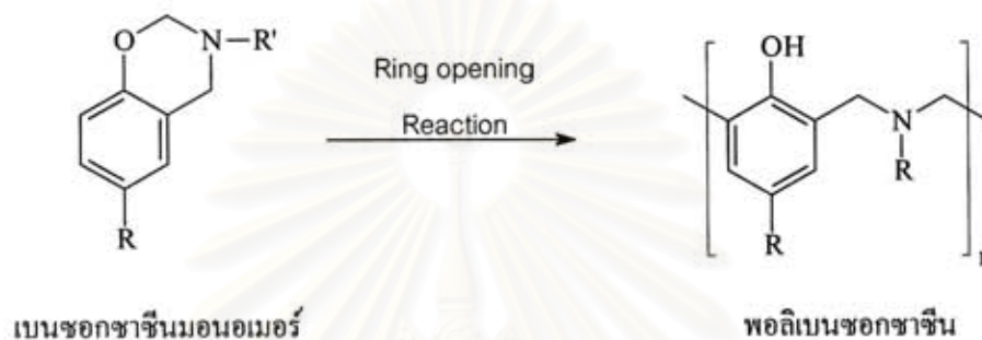
รูปที่ 4. ปฏิกริยาการเปิดวงแหวนของเบนซอกซาซีนและการนำไปสู่ยูนิตซ้ำอาซามะทิลีนฟีนอล.
