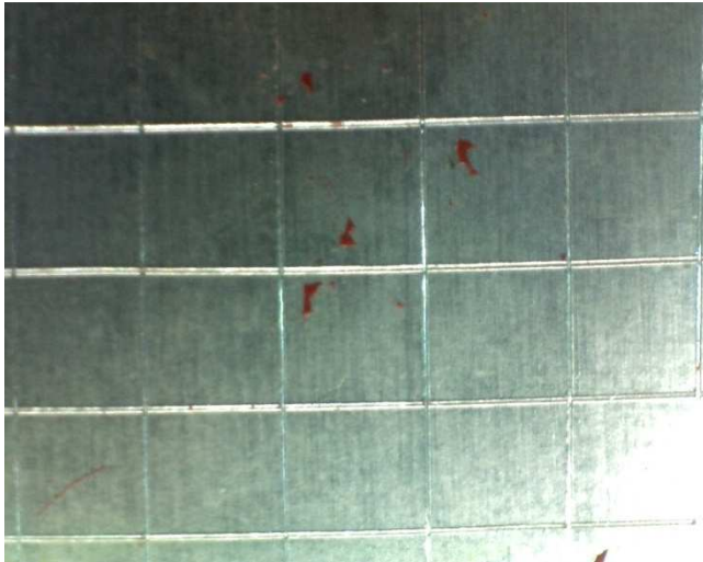
รูปที่ ผ10 ภาพถ่ายชิ้นงานเหล็กที่เคลือบผิวด้วยไททานเนียมโซลที่อัตราเร็วการเคลือบผิวต่ำ ออบชิ้นงานที่ 100 องศาเซลเซียส ตัวอย่างที่ 1 (AT-slow-100(1))
