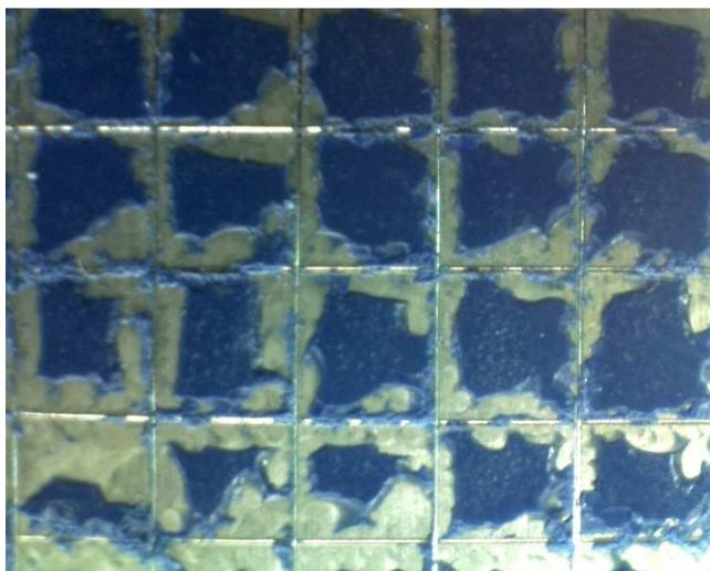
รูปที่ ๗46 ภาพถ่ายชิ้นงานเหล็กที่เคลือบผิวด้วยไฮบริดไททานเนียมโซลที่อัตราเร็วการเคลือบผิวต่ำ อบชิ้นงานที่ 100 องศาเซลเซียส ทาด้วยสีน้ำมัน ตัวอย่างที่ 1 (OTP-slow-100(1))
