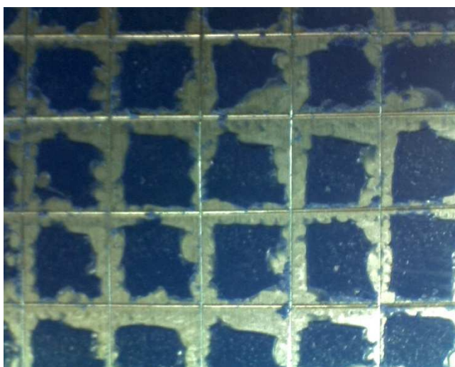
รูปที่ ๔๘ ภาพถ่ายชิ้นงานเหล็กที่เคลือบผิวด้วยไฮบริดไททานเนียมโซลที่อัตราเร็วการเคลือบผิวต่ำ อบชิ้นงานที่ 100 องศาเซลเซียส ทาด้วยสีน้ำมัน ตัวอย่างที่ 3 (OTP-slow-100(3))
