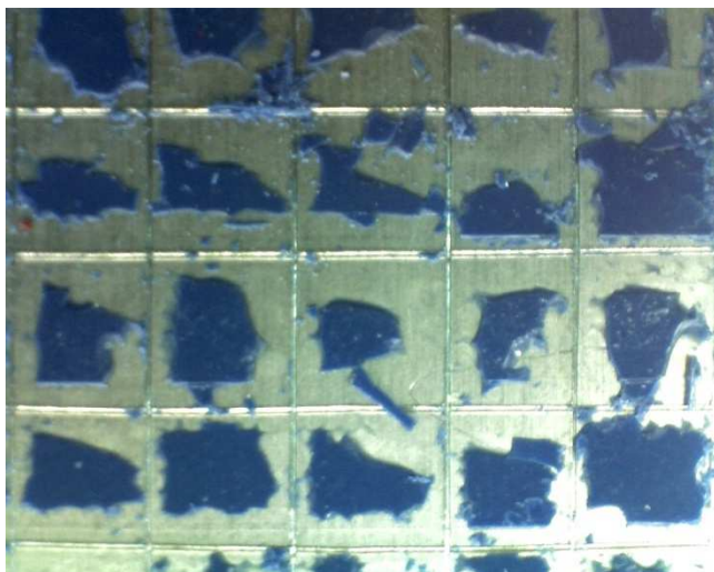
รูปที่ ๗43 ภาพถ่ายชิ้นงานเหล็กที่เคลือบผิวด้วยไฮบริดไททานเนียมโซลที่อัตราเร็วการเคลือบผิวต่ำ ทาด้วยสีน้ำมัน ตัวอย่างที่ 1 (OTP-slow-rt(1))
