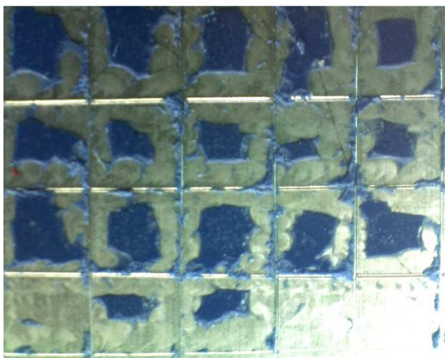
รูปที่ ผ32 ภาพถ่ายชิ้นงานเหล็กที่เคลือบผิวด้วยไททานเนียมซัลเฟตที่อัตราเร็วการเคลือบผิวต่ำ ทาด้วยสีน้ำมัน ตัวอย่างที่ 2 (OT-slow-rt(2))
