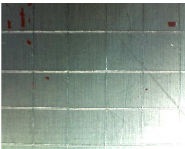
รูปที่ ๗6 ภาพถ่ายชิ้นงานเหล็กที่มีการขัดผิวด้วยกระดาษทรายและไม่เคลือบผิวด้วยโซล ฟันด้วยสีสเปรย์ ตัวอย่างที่ 3 (Blank PA3)
