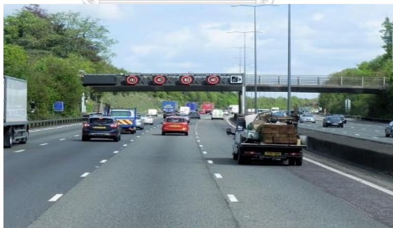
รูปที่ 2.7 ป้ายขีดจำกัดความเร็วแบบปรับเปลี่ยนแบบคร่อมถนน ,M25,ประเทศอังกฤษ แหล่งที่มา (Dixon, 2013)
