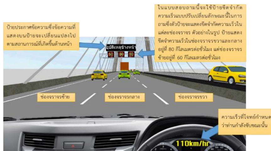
รูปที่ 3.2 การอธิบายลักษณะป้ายขีดจำกัดความเร็วแบบปรับเปลี่ยน
