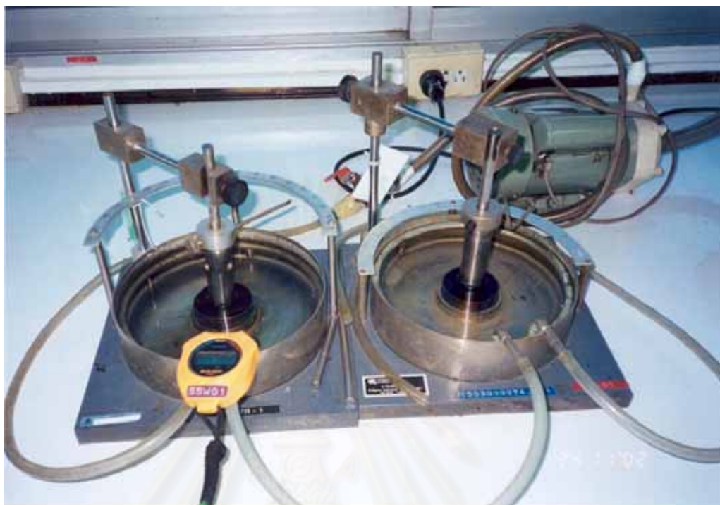
รูปที่ ค 6 ลักษณะการทดสอบสมบัติ Elastic ของวัสดุเชื่อมประสานด้วยวิธี Torsional Recovery
