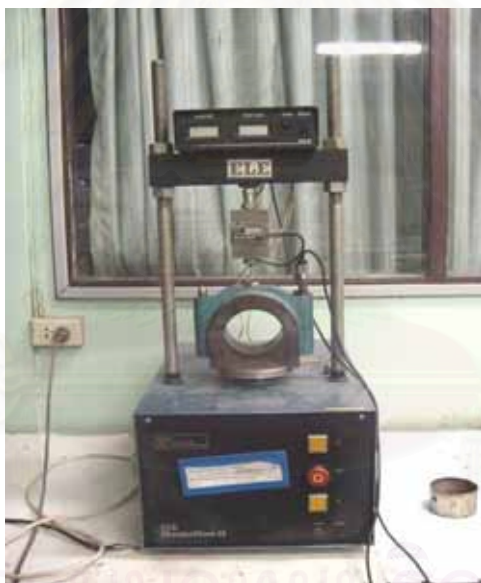
รูปที่ 2.8 เครื่องมือทดสอบเสถียรภาพและการไหลของแอสฟัลต์คอนกรีตด้วยวิธีมาร์แชล
