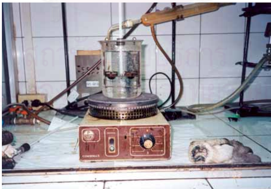
รูปที่ ค 16 การทดสอบ Softening point
