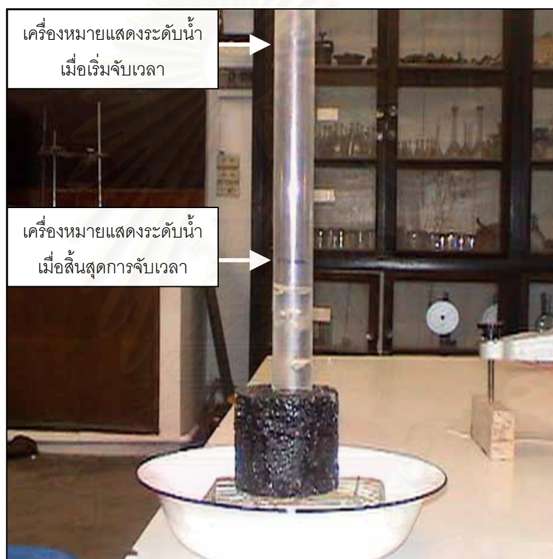
รูปที่ 3.18 การทดสอบหาความสามารถในการระบายน้ำ
