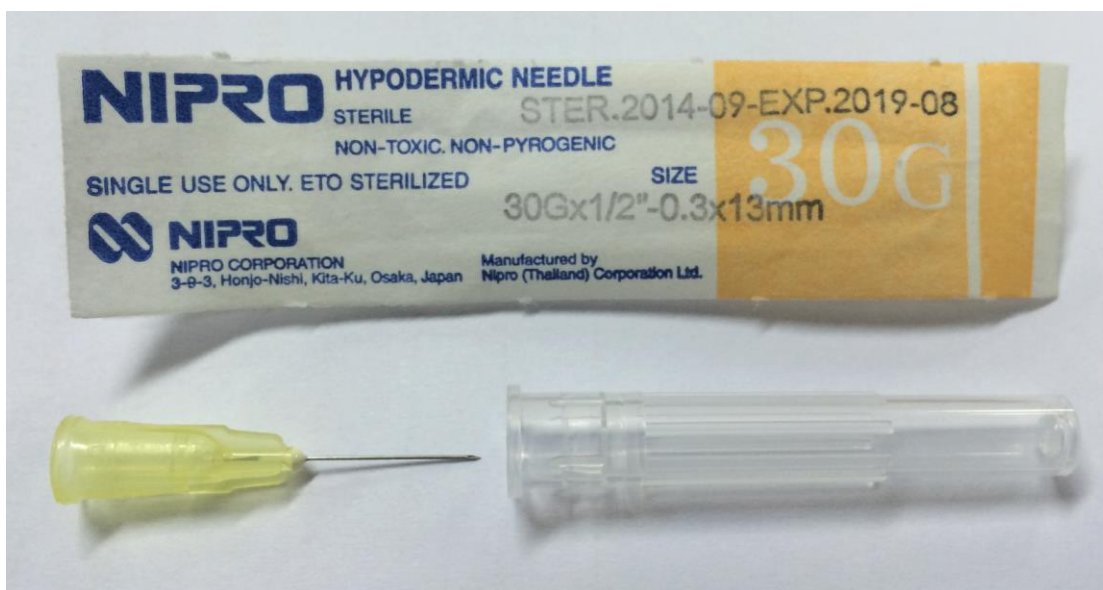
รูปที่ 3.1 ชุดเข็มฉีดยาขนาด 30G สำหรับใช้สร้างแม่พิมพ์พอลิเมอร์
