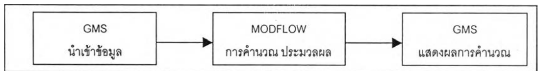
รูปที่ 3-2 โครงสร้างการทำงานระหว่าง GMS และ MODFLOW
