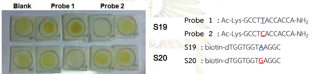
รูปที่ 3.14 ผลการทดสอบประสิทธิภาพของดีเอ็นเอเซ็นเซอร์ต่อการจับยึดกับดีเอ็นเอคู่สมจากความจำเพาะเจาะจงกับดีเอ็นเอเป้าหมายที่เป็นคู่สมโดยหยดดีเอ็นเอคู่สมโดยตรง
