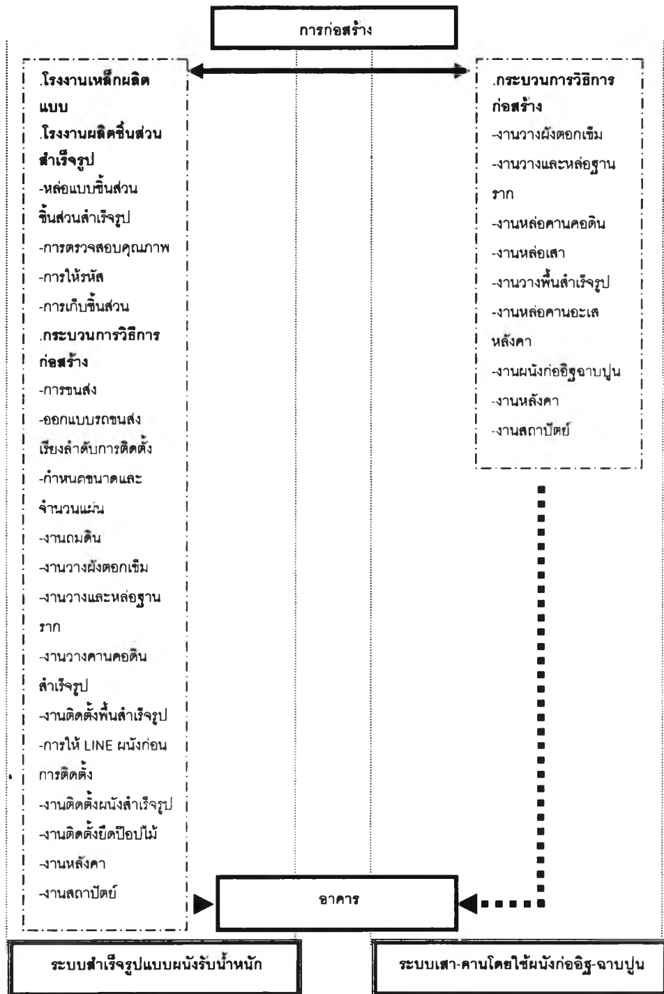
แผนภูมิที่ 6.7 แสดงการวิเคราะห์ขั้นตอน และวิธีการก่อสร้าง(ต่อ)
