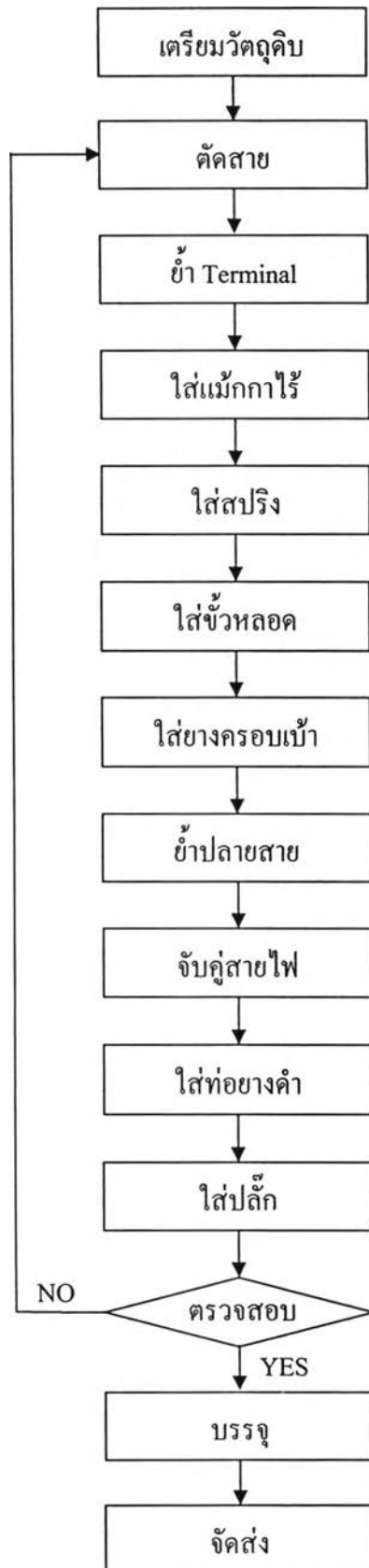
รูปที่ 3.14 กระบวนการผลิตชุดสายไฟน้ำรถจักรยานยนต์
