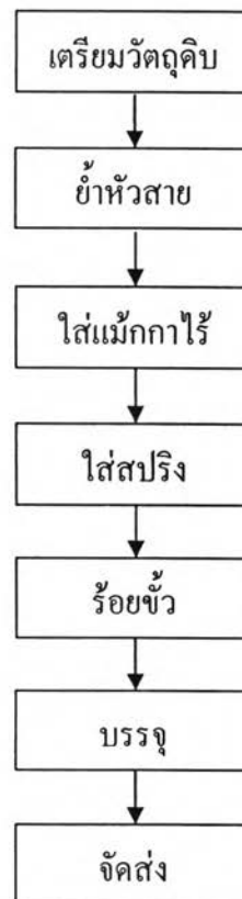
รูปที่ 3.12 กระบวนการผลิตงานสายไฟ
