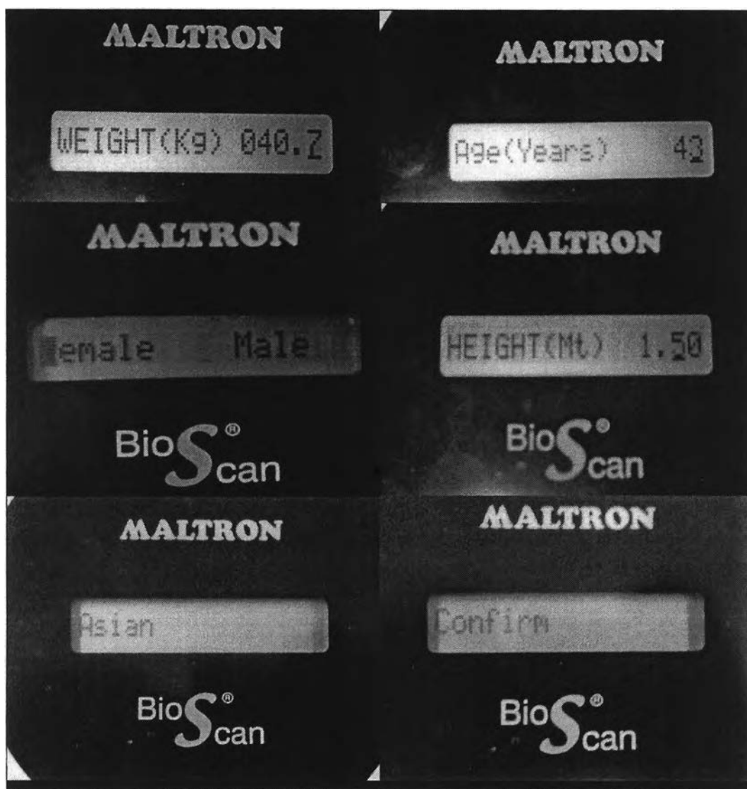
รูปที่ 23 แสดงข้อมูลที่ต้องบันทึกเพื่อทำการวัด bioelectrical impedance
