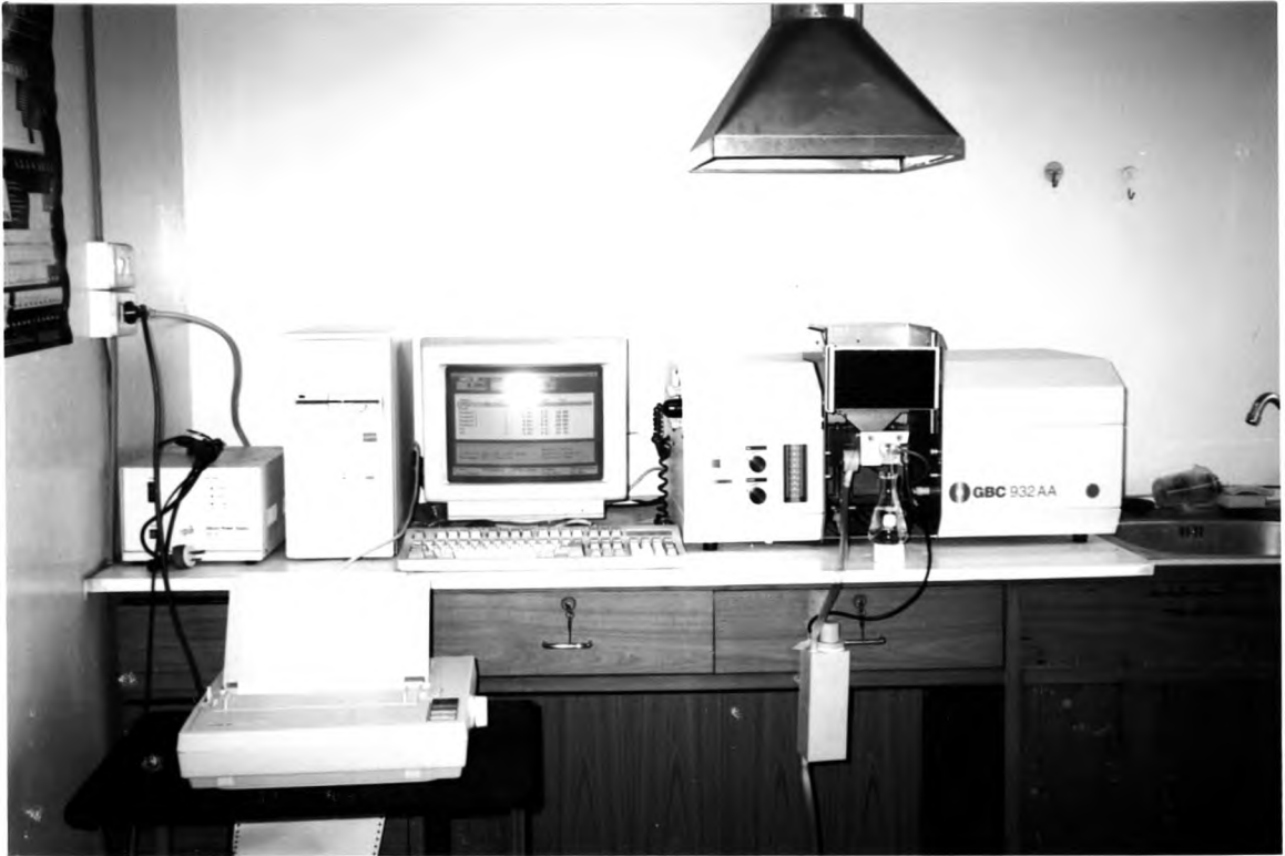
รูปที่ 9 เครื่องอะตอมมิกแอบซอร์พชันสเปกโตรโฟโตมิเตอร์ รุ่น 932 บริษัท GBC Scientific Equipment PTY, Ltd. Australia
