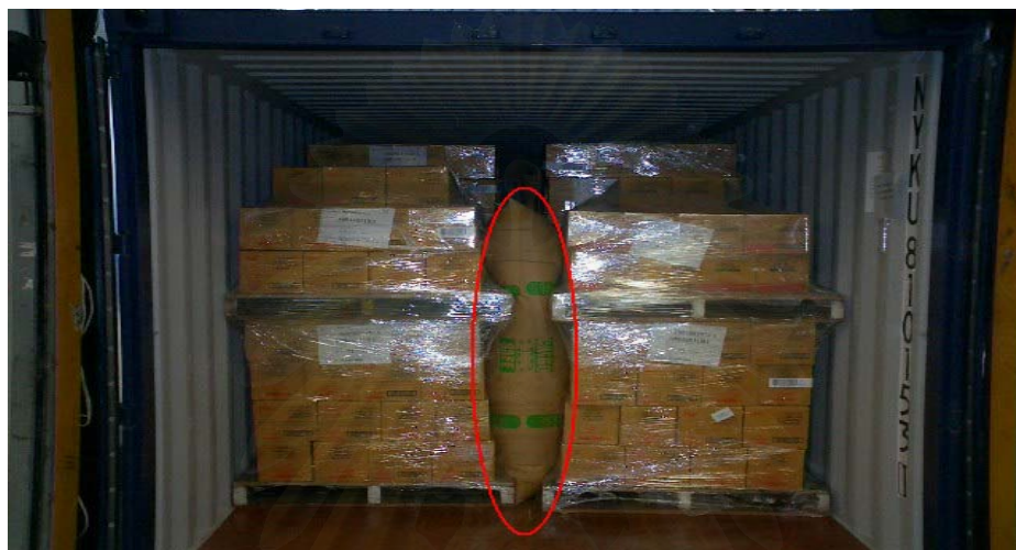
รูปที่ 4.3 การใช้ Airbag เพื่อป้องกันสินค้าเสียหายในการส่งออกไปประเทศที่ห้ามนำไม้เข้าประเทศ
