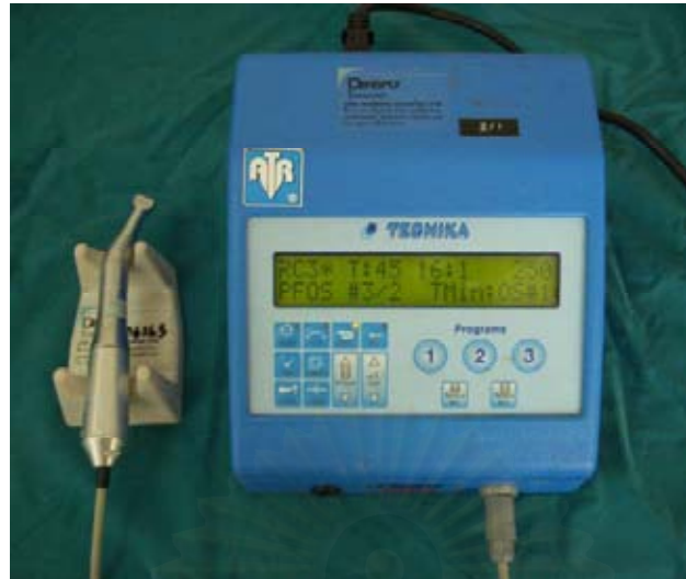
ภาพที่ 9 แสดงมอเตอร์ไฟฟ้าควบคุมความเร็ว และด้ามกรอฟันที่ติดกับมอเตอร์ไฟฟ้าควบคุมความเร็ว สำหรับไฟล์แบบหมุนด้วยเครื่องชนิดโพรไฟล์
