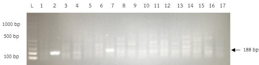
รูปที่ 4. 45 ผลการทดสอบความจำเพาะของไพรเมอร์ MAV gyrB RPA ด้วยปฏิกิริยา RPA เมื่อเมื่อตรวจสอบผลผลิตด้วย Agarose gel electrophoresis ความเข้มข้น 2%
