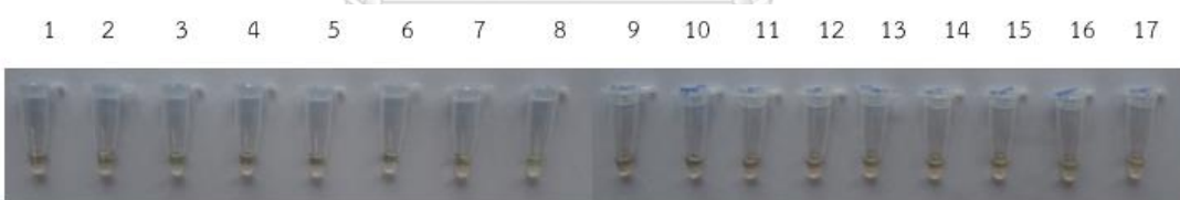
รูปที่ 4. 43 ผลการทดสอบความจำเพาะของไพรเมอร์ MIN gyrB RPA ด้วยปฏิกิริยา RPA เมื่อตรวจสอบผลผลิตด้วยสี SYBR Green I ความเข้มข้น 400X
