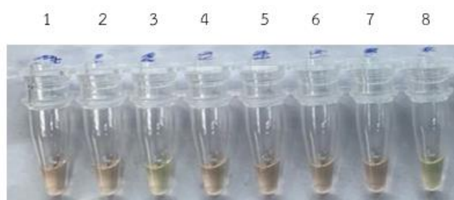
รูปที่ 4. 53 ผลการเพิ่มปริมาณสารพันธุกรรมเชื้อ MAC เมื่อทดสอบด้วยไพรเมอร์ MAV gyrB ด้วยปฏิกิริยา RPA เมื่อตรวจสอบผลผลิตด้วยสี SYBR Green I ความเข้มข้น 400X
