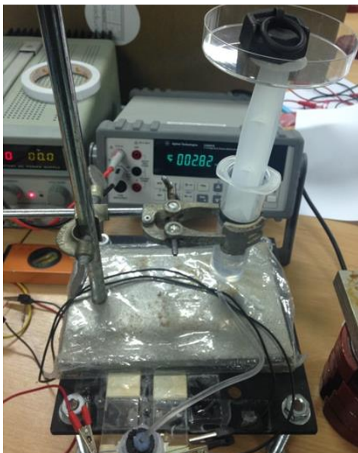
รูปที่ 4.8 การให้ความดันแก่ระบบโดยการถ่วงมวล 0.1 กิโลกรัม
