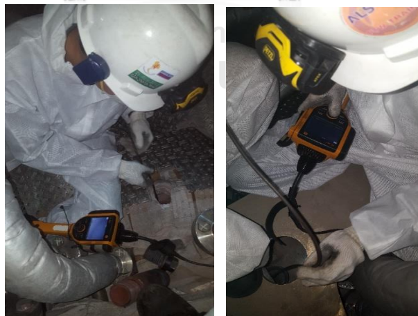
รูปที่ 2.22 การใช้ Bore Scope ตรวจสอบความสภาพเครื่องกังหันก๊าซ
