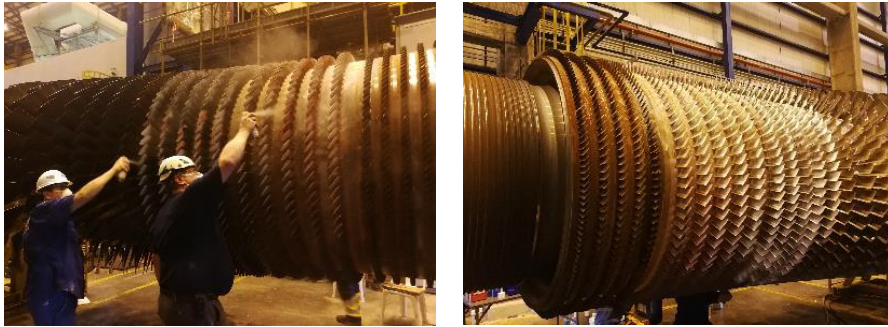
รูปที่ 2.26 การตรวจสอบด้วยสารแทรกซึมตำแหน่ง Compressor Blade
