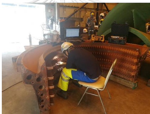
รูปที่ 2.28 การตรวจสอบ Compressor Vane วิธี Eddy Current Testing
