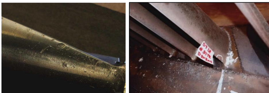
รูปที่ 2.15 Compressor Blade ที่ถูกกระแทกจากสิ่งแปลกปลอมภายนอก(5)
