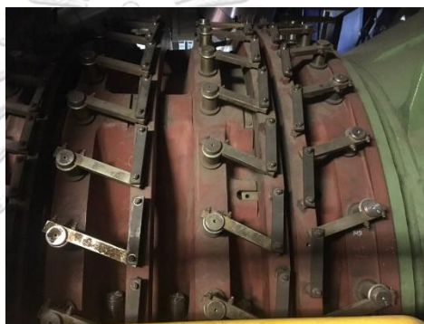
รูปที่ 2.9 ตำแหน่ง Casing ที่ติดตั้ง Variable Guide Vane
