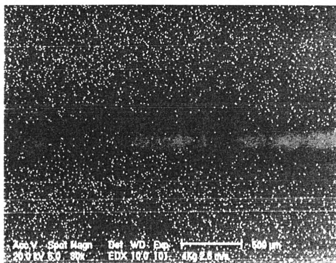
รูปที่ 4.12 ลักษณะการวิเคราะห์ธาตุของเหล็กกล้าที่เคลือบผิวเป็นวานาเดียมคาร์ไบด์ กรณีน้ำหนักที่หายไป 0.0033 กรัม ที่น้ำหนักกด 4 กิโลกรัม ความเร็วจาน 2.6 เมตรต่อวินาที ระยะทดสอบ 8250 เมตร ก) บริเวณขอบรอยเสียดสี ข) ธาตุเหล็ก ค) ธาตุวานาเดียม
