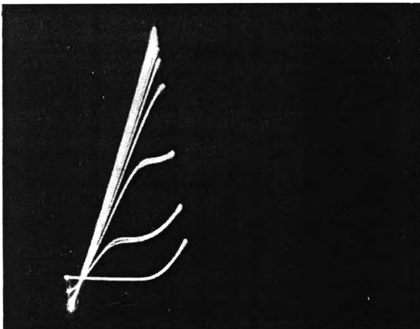
รูปที่ 4.29 ลักษณะสมบัติกระแส-แรงดันของทรานซิสเตอร์โครงสร้างเมฆาใน Inverted Mode ของ TR(0.35,0.4)
