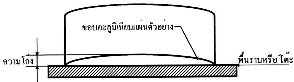
รูปที่ WI 8.1 การวัดความโค้งตามแนวยาว (ข้อ 5.2.2)
