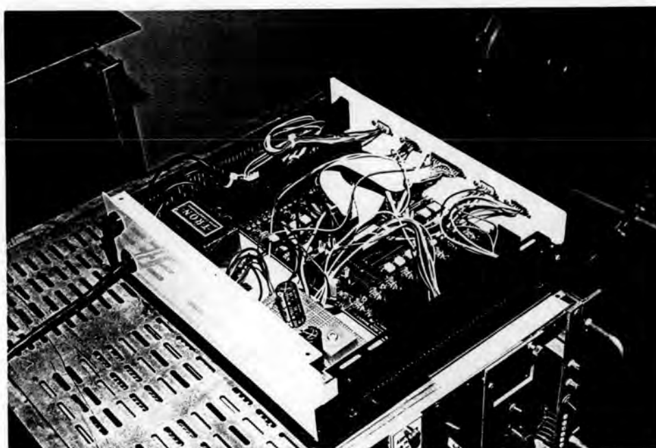
รูปที่ 3.10 วงจรขับสเต็ปมอเตอร์
