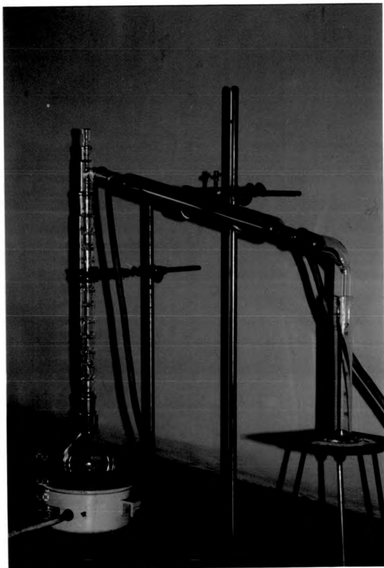
รูป ก.2 ชุดกลั่นสำหรับวิเคราะห์ค่า TBA
