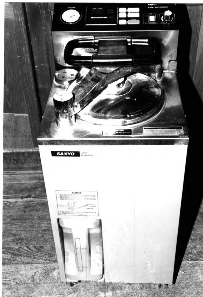
รูปที่ 3.4 หม้อน้ำความดันอัตโนมัติ
