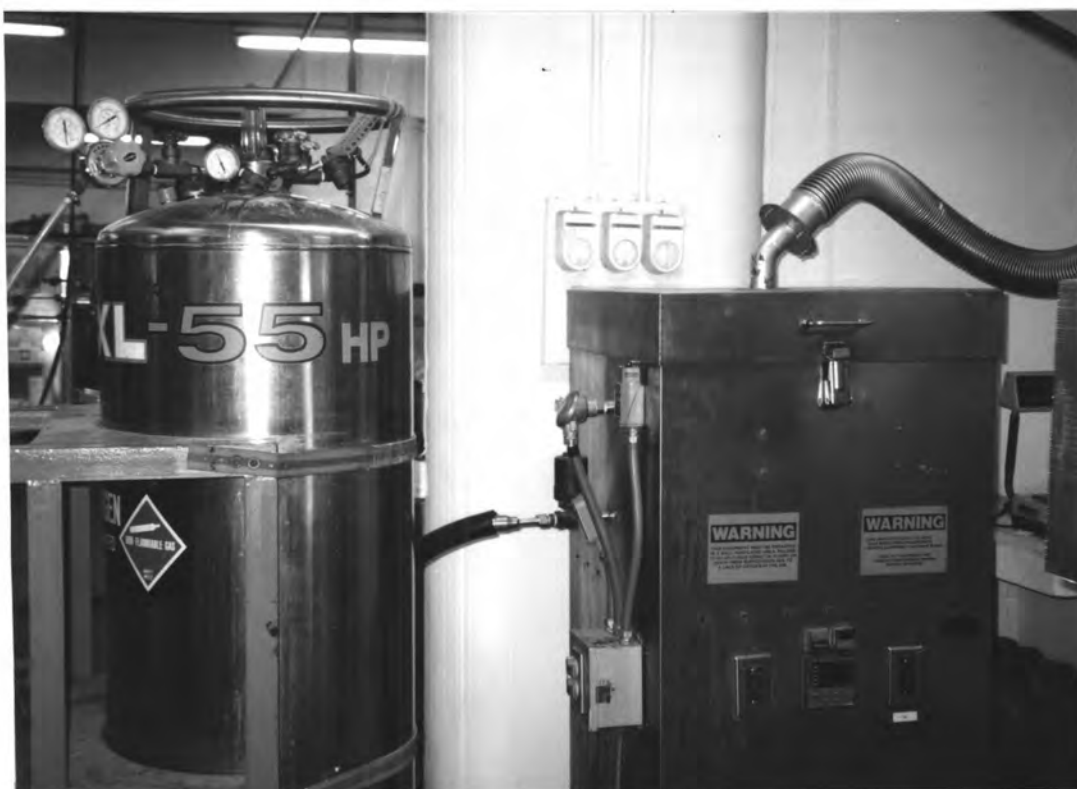
๑.2 ถังบรรจุไนโตรเจนเหลวและ cryo-test chamber
