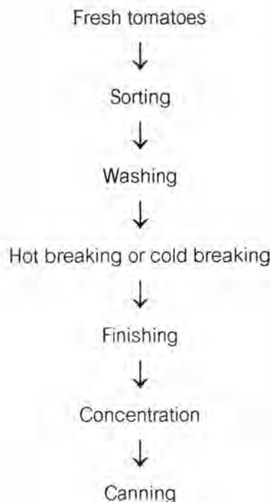
รูปที่ 1.1 กระบวนการผลิตมะเขือเทศเข้มข้น ที่มา: Goose และ Binsted (1973)
