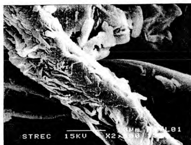
รูปที่ 4.3 ภาพถ่ายด้วยกล้องจุลทรรศน์อิเล็กตรอนของผงฝ้าย ที่กำลังขยาย 2,500 เท่า (1) ผงฝ้ายที่ไม่ได้ปรับปรุง (2) ผงฝ้ายที่ปรับปรุงด้วย MAHPP และ (3) ผงฝ้ายที่ปรับปรุงด้วยกรดสเดียม
