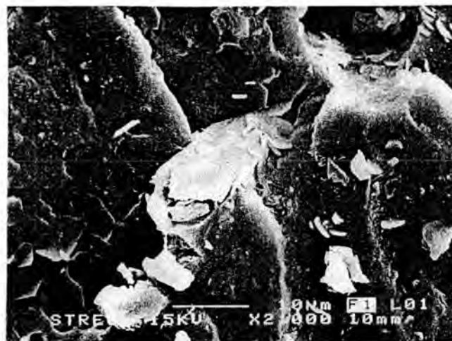
รูปที่ 4.23 ภาพถ่ายด้วยกล้องจุลทรรศน์อิเล็กตรอนของพื้นผิวที่แตกหักของวัสดุเชิงประกอบ ที่ปริมาณผงฝ้าย 20% โดยน้ำหนัก กำลังขยาย 2000 เท่า (1) วัสดุเชิงประกอบฝ้าย (2) วัสดุเชิงประกอบฝ้าย-MAHPP และ(3) วัสดุเชิงประกอบฝ้าย-สเดียริก
