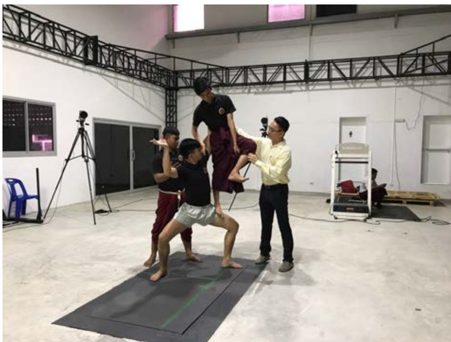
ภาพที่ 141 ขณะทำการทดสอบด้วยแท่นวัดแรง (Bertec) ที่มา : เฉลิมชัย ภิรมย์รักษ์ (2561)
