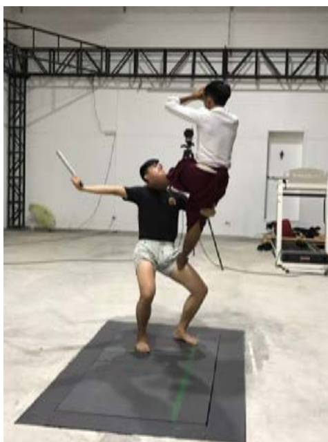
ภาพที่ 139 ขณะทำการทดสอบด้วยแท่นวัดแรง (Bertec) ที่มา : เฉลิมชัย ภิรมย์รักษ์ (2561)
