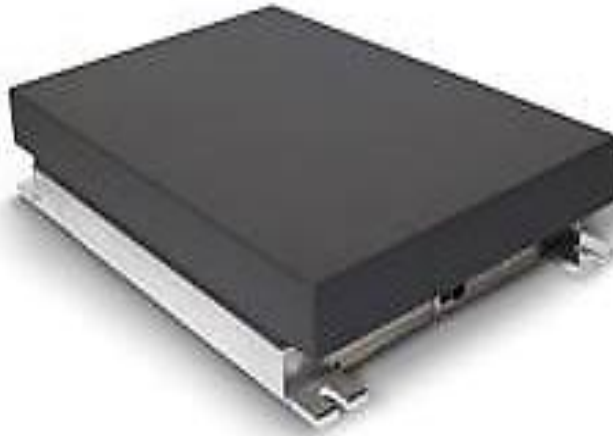
ภาพที่ 134 แผ่นวัดแรง (Bertec) ที่มา : เฉลิมชัย ภิรมย์รักษ์ (2561)
