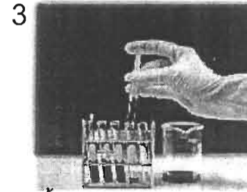
3 เติมน้ำยา KKU-DCIP-Clear Reagent (สีน้ำเงิน) ลงในหลอดแก้ว 2 มล.
