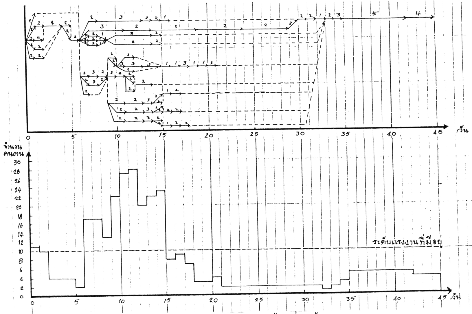
รูปที่ ๕๒๑ กราฟแสดงระดับความต้องการแรงงานของงานประกอบรวมขั้นสุดท้ายเครื่องบินต้นแบบ พอ. ๕ เมื่อเหตุการณ์ทุกเหตุการณ์เริ่มต้นอย่างรวดเร็วที่สุด
