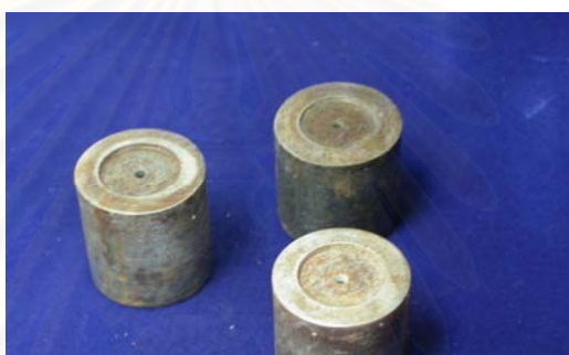
รูปที่ 9 แสดงแบบช่วยยึดชิ้นตัวอย่างขณะขัด
