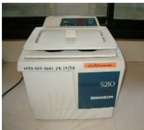
รูปที่ 11 แสดงเครื่องทำความสะอาดด้วยคลื่นความถี่เหนือเสียง (Ultrasonic cleanser) รุ่น 5210 , Bransonic , Germany
