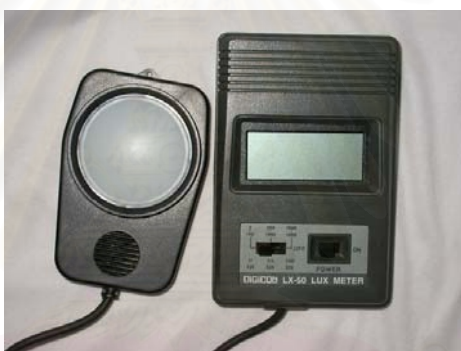
รูปที่ 12 แสดงเครื่องวัดความส่องสว่างของแสง (Digital Lux Meter) Model LX-50
