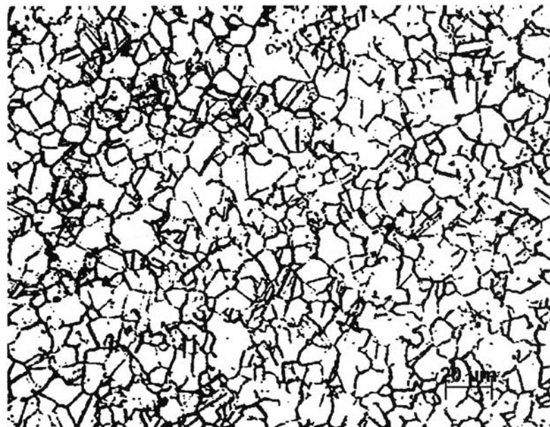
รูปที่ ๘ โครงสร้างจุลภาคของสลักเกลียวหลังผ่านการอบละลาย 885 (24) ตามด้วยบ่มแข็ง 760 (20) และทดสอบการคลายความเค้นที่อุณหภูมิ 760 องศาเซลเซียส เป็นเวลา 1,500 ชั่วโมง ขนาดเกรน ASTM, G11 ที่กำลังขยาย 200 เท่า ถ่ายภาพโดยกล้องจุลทรรศน์แบบแสง
