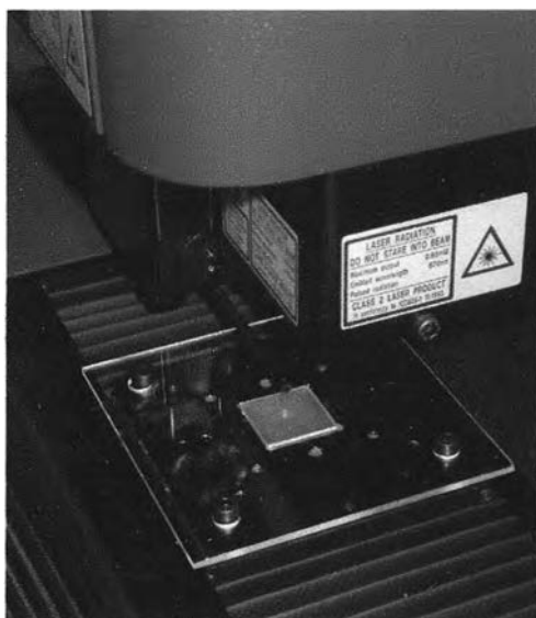
รูปที่ 27 แสดงการวัดความหยาบของชิ้นตัวอย่างด้วยเครื่อง profilometer
