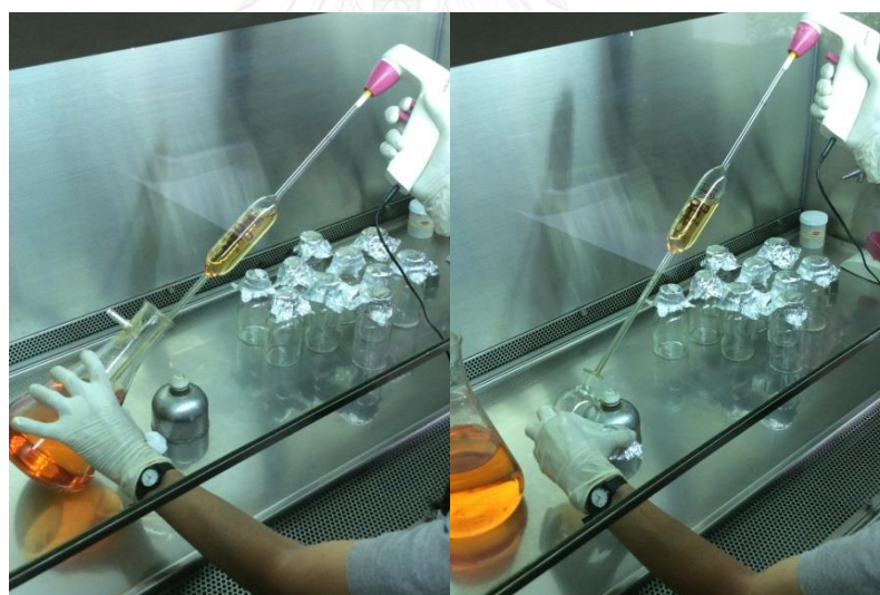
ภาพที่ 7 การแบ่งอาหารเลี้ยงเชื้อหลังจากการกรองใส่ขวดแก้วปราศจากเชื้อ
