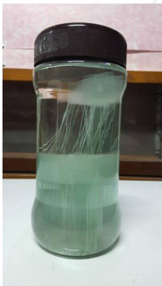
ภาพที่ 29 กระจกสไลด์แช่ในแอลกอฮอล์ 95%
