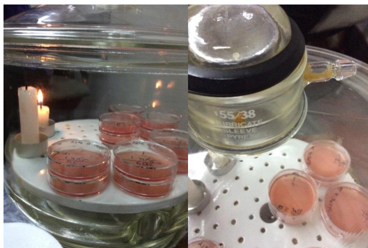
ภาพที่ 12 การปิดช่องอากาศที่อยู่ส่วนบนของฝา (stop – cock) เมื่อเทียนไขใกล้ดับ
