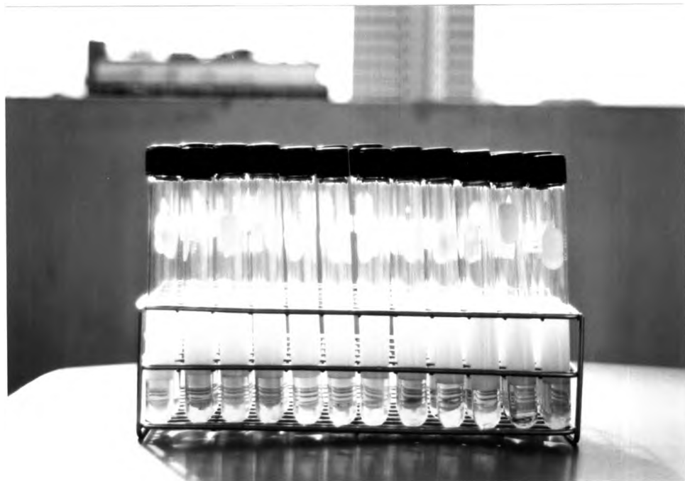
รูปที่ 41 แสดงลักษณะอิมัลชัน ที่เกิดจากการผสมของน้ำเลี้ยงเชื้อ กับน้ำมันก๊าด
