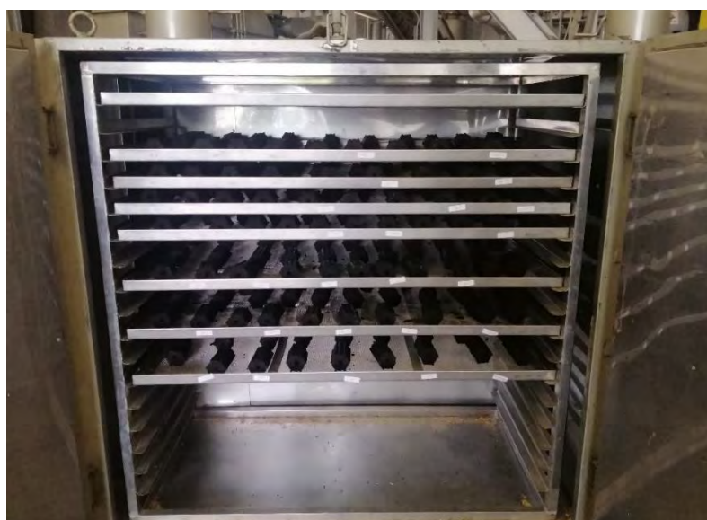
รูปที่ 2 กระบวนการทำให้แห้งของถ่านอัดแท่งโดยใช้เครื่องอบแห้ง
