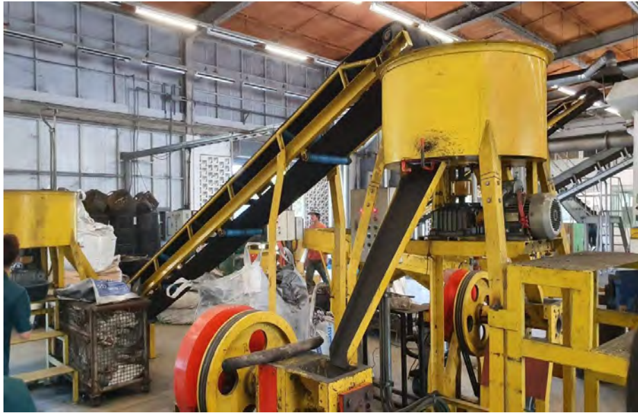
รูปที่ 7 เครื่องจักรอัดแท่งแบบสกรู ขนาด 10 แรงม้า
