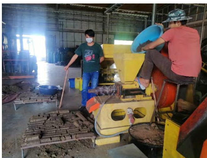
รูปที่ 30 วิธีการอัดแท่งมูลวัวนมแห้งก่อนการทำคาร์บอนเซชัน
