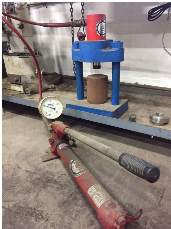
รูปที่ 8 เครื่องอัดไฮดรอลิกแบบมือโยกพร้อมแท่นอัดขนาด 70 เมกะปาสคาล
