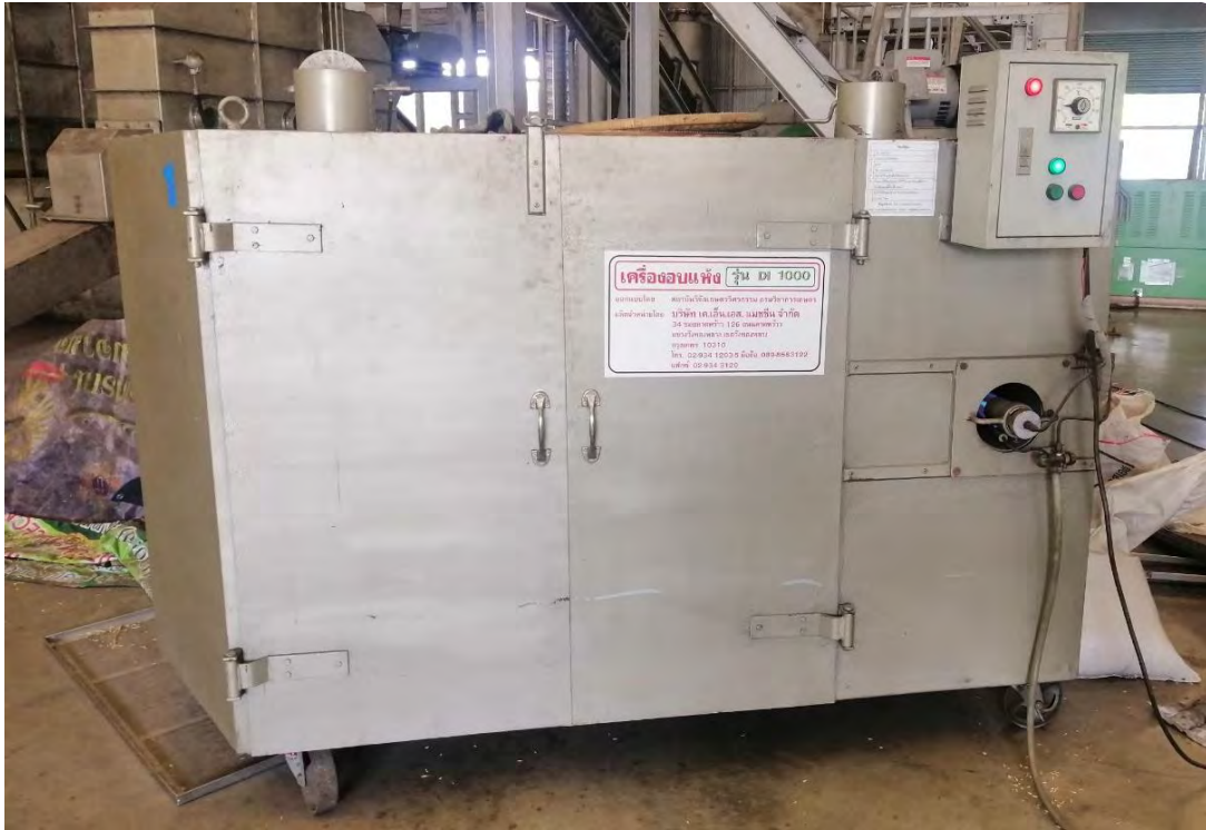
รูปที่ 9 เครื่องอบแห้งขนาด 2300 ลิตร อุณหภูมิ 70 องศาเซลเซียส
