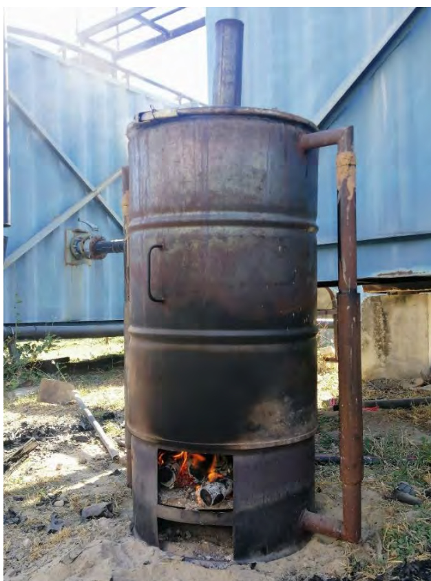
รูปที่ 31 วิธีการทำคาร์บอนเซชัน โดยการเผาในเตา
