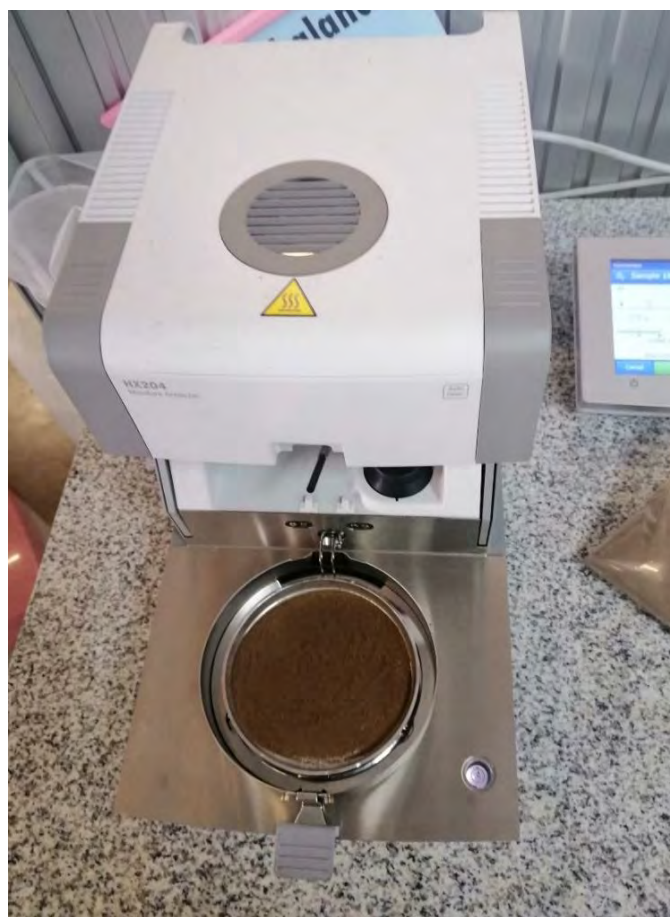
รูปที่ 33 เครื่องมือในการวัดปริมาณความชื้นด้วย MATTler TOLEDO Moisture Analyzer
