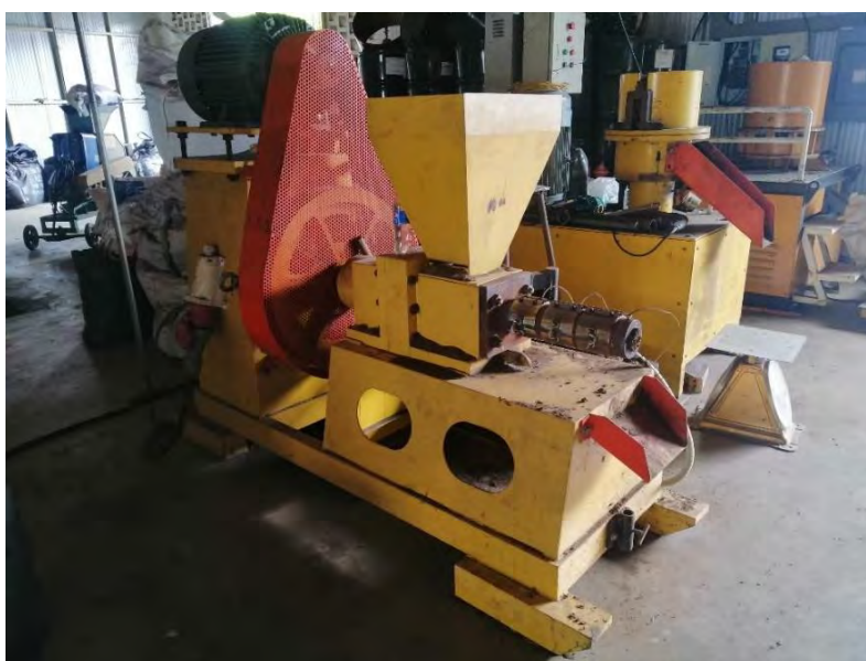
รูปที่ 6 เครื่องจักรอัดแท่งแบบสกรูพร้อมระบบฮีตเตอร์ขนาด 25 แรงม้า
