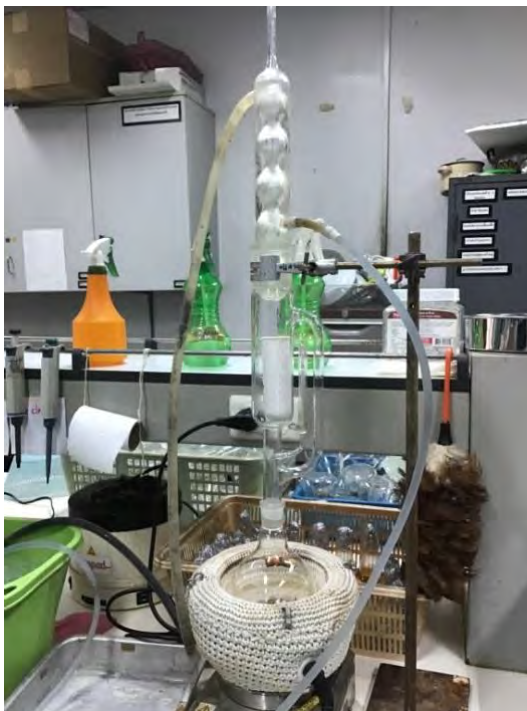
รูปที่ 3.1 การสกัดสารด้วยเครื่อง Soxhlet extraction
