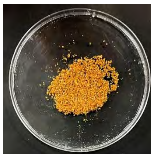
รูปที่ 4.2 แกลบข้าวที่ผ่านการกำจัดซิลิกาและเฮมิเซลล์ูโลส
