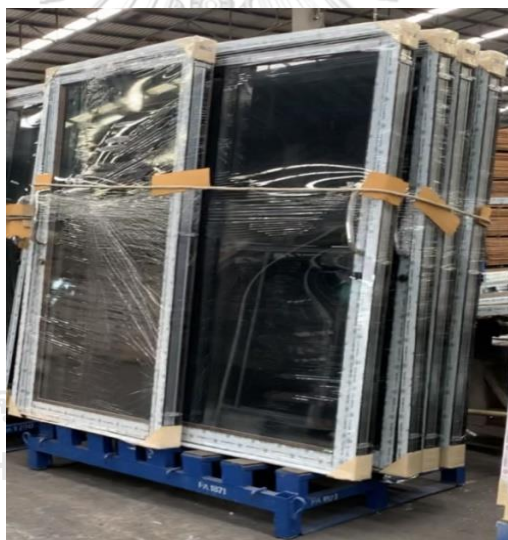
ภาพที่ 88 ประตูบานเปิดเดี่ยวที่ประกอบเสร็จจากโรงงาน พร้อมขนส่งไปที่โครงการ
