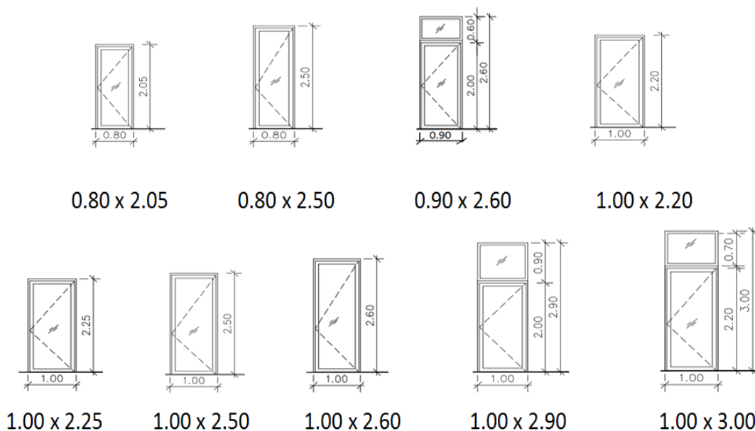
ภาพที่ 108 รูปแบบประตูบานเปิดเดี่ยว 9 ขนาด ในอาคารกรณีศึกษา
