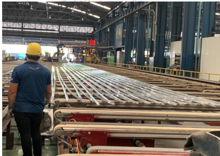
ภาพที่ 44 เส้นอลูมิเนียมที่ถูกรีดออกจากเครื่อง
