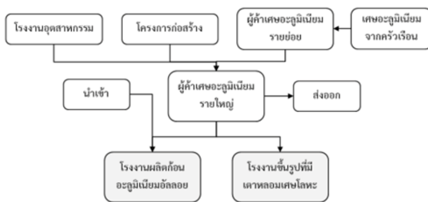
ภาพที่ 31 แผนผังแหล่งที่มาและการหมุนเวียนเศษอลูมิเนียม
