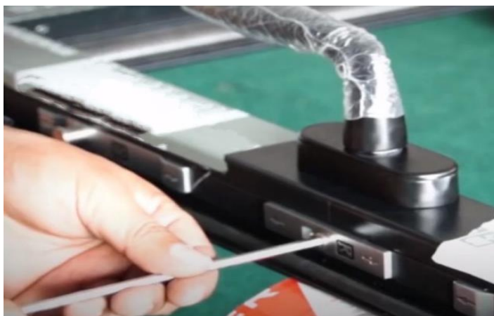
ภาพที่ 83 การติดมือจับ
