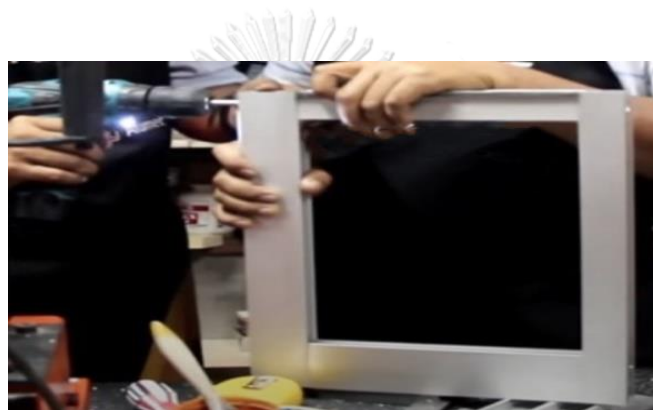
ภาพที่ 28 การประกอบบานกรอบเข้ากับกระจก ที่มา : https://www.youtube.com/watch?v=GfKo86JzanM .
