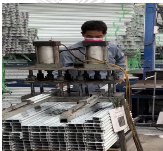
ภาพที่ 68 การตัดเส้นอลูมิเนียมในโรงงาน
