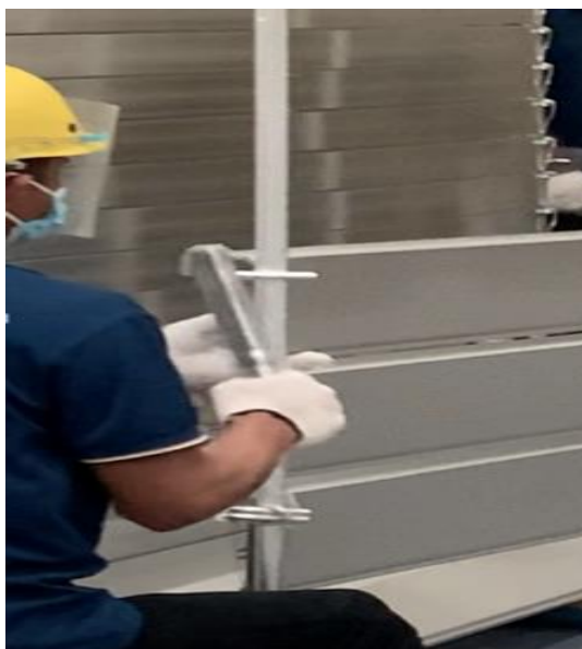
ภาพที่ 46 การตอกอุปกรณ์ยึดเส้นอลูมิเนียม
