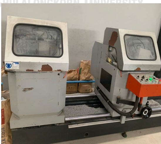
ภาพที่ 69 เครื่องตัดเส้นอลูมิเนียมแบบ 2 หัว
