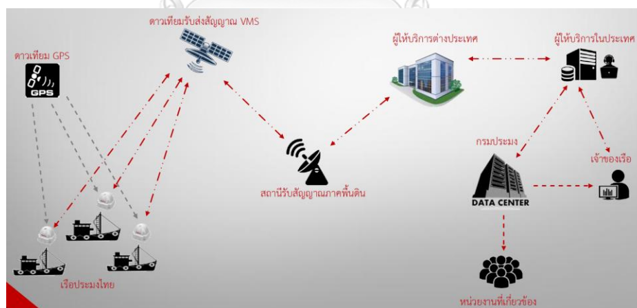
ภาพที่ 11 หลักการทำงานของระบบติดตามเรือประมง (VMS) ที่มา: กรมประมง (2564)
