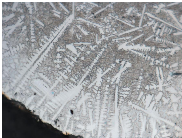
รูปที่ 4.11 ชิ้นงานที่ A1 ความดันแก๊สช่วยตัดที่ 8bar ความเร็วการตัด 4000mm/sec กำลังของเลเซอร์ 1kW
