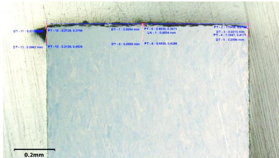
รูปที่ 4.59 ลักษณะชั้น HAZ ของชิ้นงานที่ B2N
