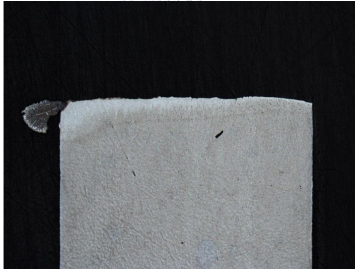
รูปที่ 4.11 ชิ้นงานที่ A1 ความดันแก๊สช่วยตัดที่ 8bar ความเร็วการตัด 4000mm/sec กำลังของเลเซอร์ 1kW
