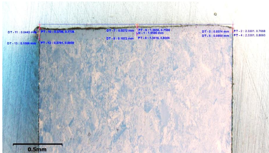
รูปที่ 4.62 ลักษณะชั้น HAZ ของชิ้นงานที่ G6
