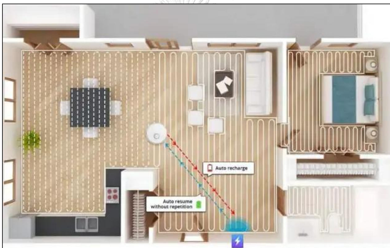
รูปที่ 2.2 การสร้างแผนที่ด้วยระบบวัดระยะทางด้วยแสงสำหรับหุ่นยนต์ทำความสะอาด
