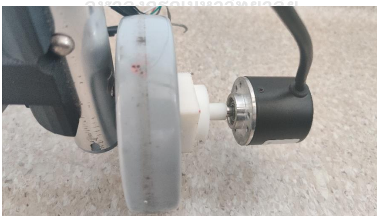
รูป 3.5 โรตารีเอนโคเดอร์ที่ติดตั้งบนล้อของอุปกรณ์ช่วยเดิน
